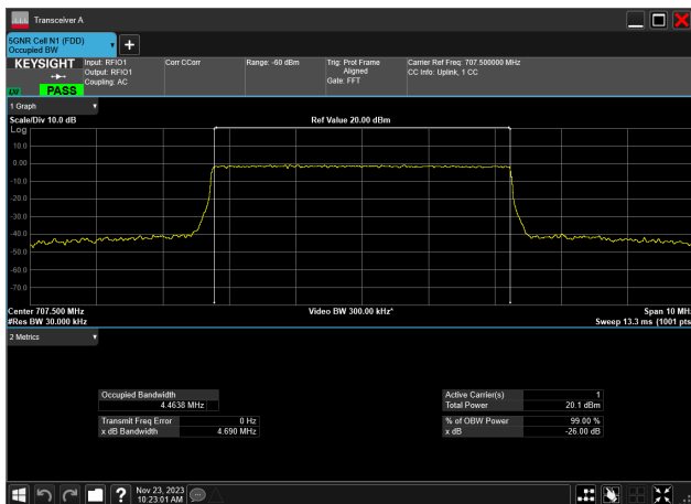
5MHz_15kHz_707.5MHz_CP-OFDM QPSK_RB25@0 4.464 MHz
