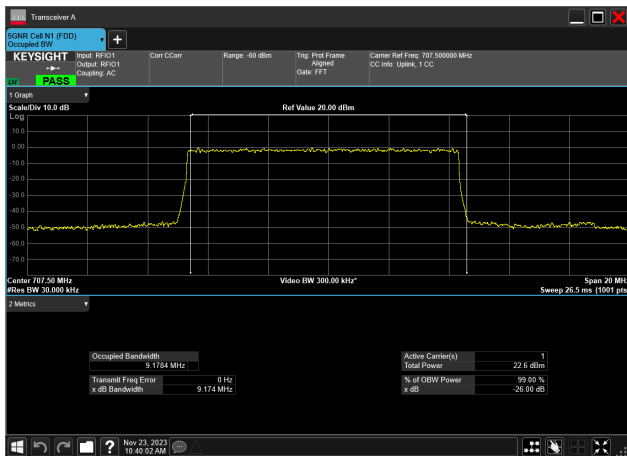
10MHz_15kHz_707.5MHz_DFT-s-OFDM PI/2 BPSK_RB50@0 9.178 MHz
