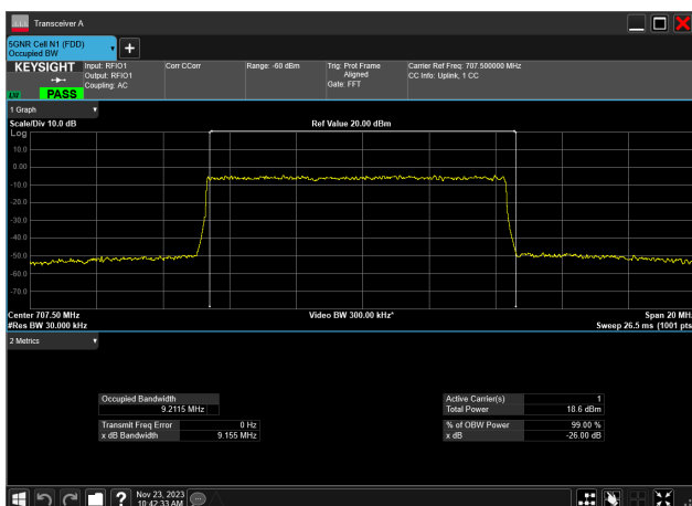
10MHz_15kHz_707.5MHz_DFT-s-OFDM 256 QAM_RB50@0 9.212 MHz
