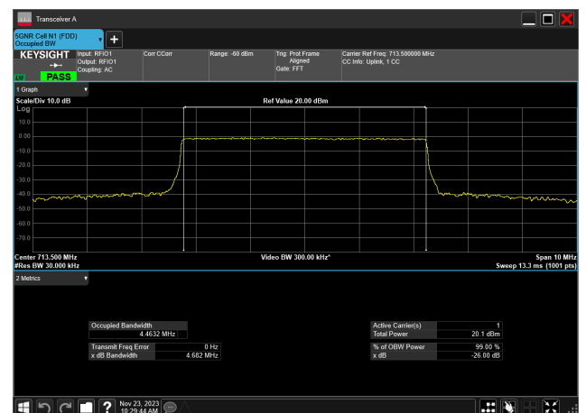
5MHz_15kHz_713.5MHz_CP-OFDM QPSK_RB25@0 4.463 MHz
