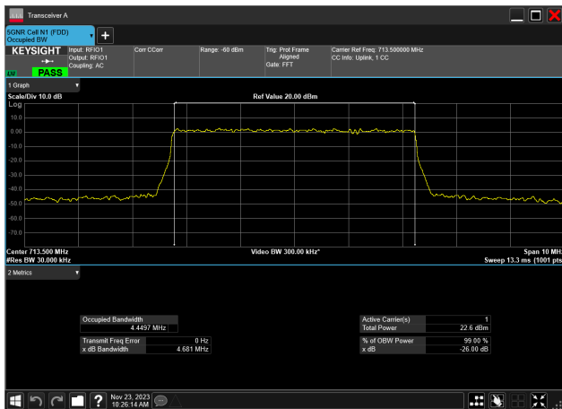
5MHz_15kHz_713.5MHz_DFT-s-OFDM PI/2 BPSK_RB25@0 4.450 MHz
