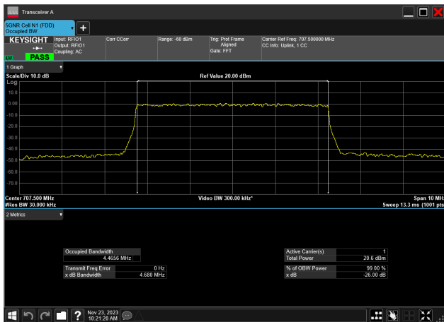
5MHz_15kHz_707.5MHz_DFT-s-OFDM 64 QAM_RB25@0 4.466 MHz
