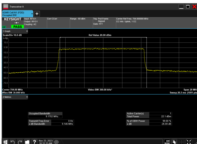
10MHz_15kHz_704MHz_DFT-s-OFDM QPSK_RB50@0 9.170 MHz
