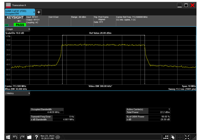
5MHz_15kHz_713.5MHz_DFT-s-OFDM QPSK_RB25@0 4.464 MHz
