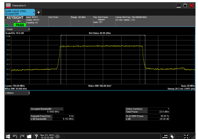
10MHz_15kHz_704MHz_DFT-s-OFDM PI/2 BPSK_RB50@0 9.166 MHz
