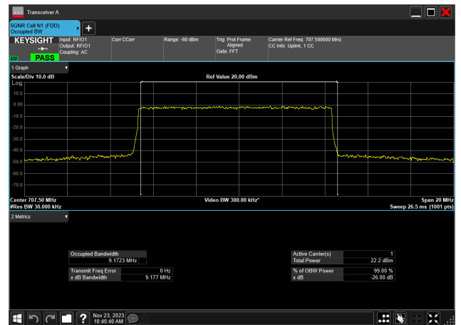
10MHz_15kHz_707.5MHz_DFT-s-OFDM QPSK_RB50@0 9.172 MHz
