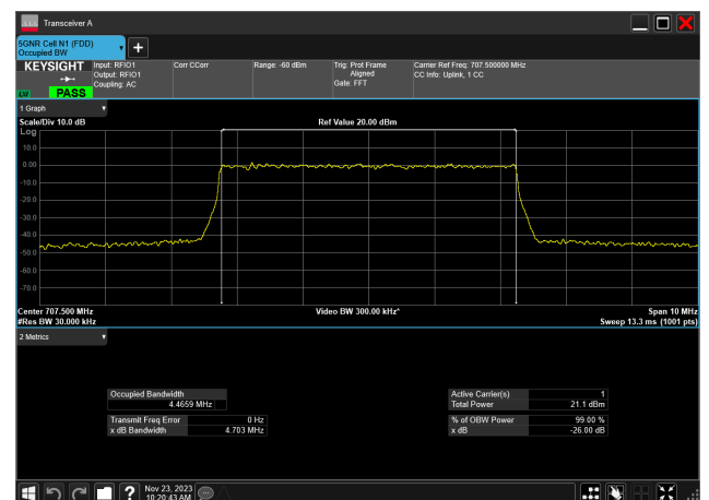
5MHz_15kHz_707.5MHz_DFT-s-OFDM 16 QAM_RB25@0 4.466 MHz
