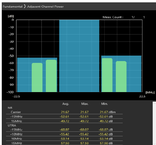
15MHz_30kHz_3692.5MHz-OFDM QPSK_RB1@37 -52.61,-49.72dB
