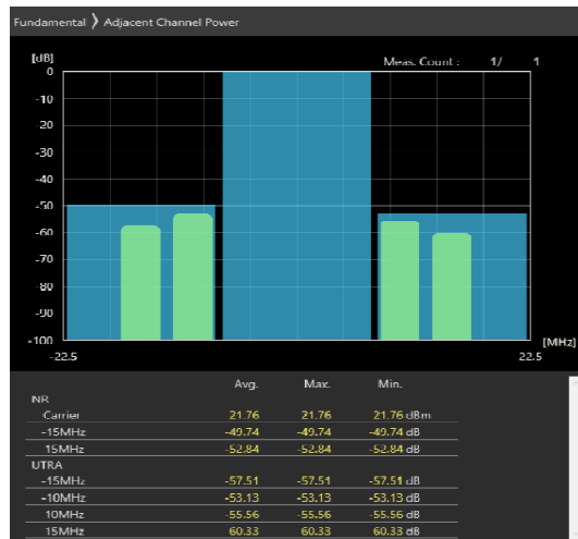
15MHz_30kHz_3692.5MHz-OFDM QPSK_RB18@9 -48.58,-49.69dB
