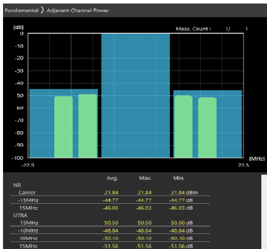
15MHz_30kHz_3692.5MHz-OFDM QPSK_RB1@37 -52.61,-49.72dB
