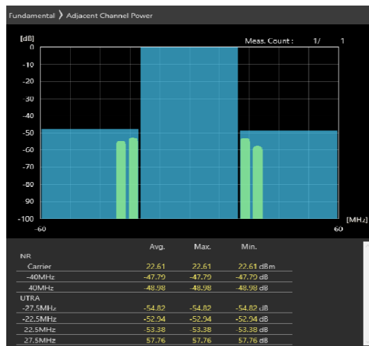
40MHz_30kHz_3680MHz-OFDM QPSK_RB50@25 -47.79,-48.98dB
