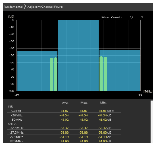
50MHz_30kHz_3675MHz-OFDM QPSK_RB64@32 -47.32,-48.49dB
