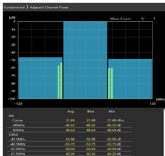
80MHz_30kHz_3660MHz-OFDM QPSK_RB108@54 -46.18,-46.14dB
