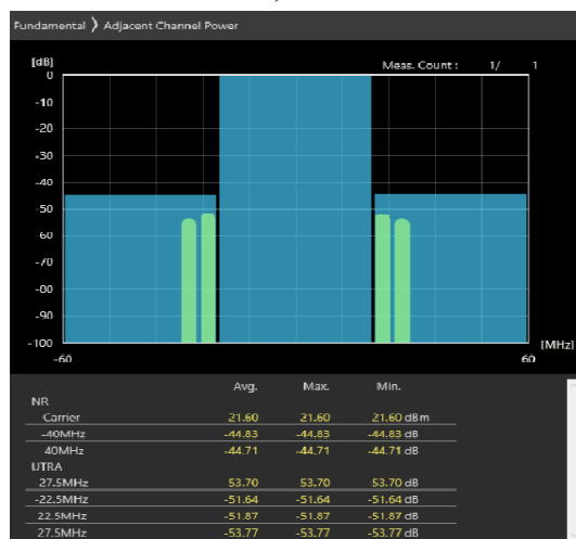
40MHz_30kHz_3680MHz-OFDM QPSK_RB50@25 -47.59,-48.82dB
