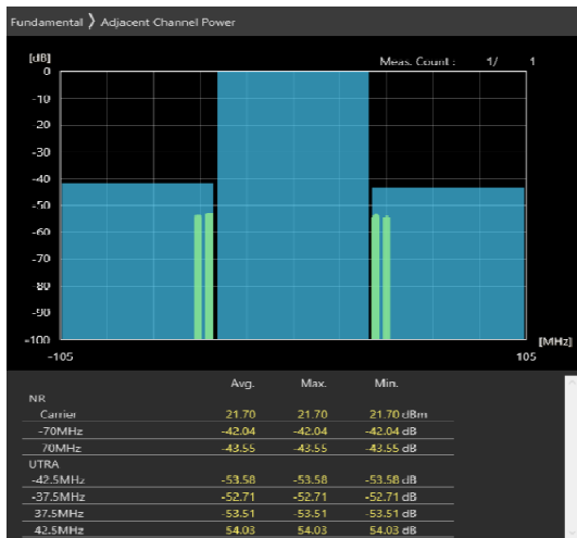
70MHz_30kHz_3585MHz-OFDM QPSK_RB90@45 -45.03,-46.86dB
