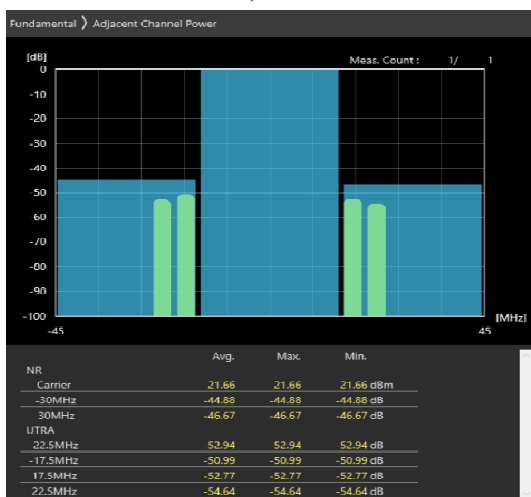
30MHz_30kHz_3685MHz-OFDM QPSK_RB36@18 -48.07,-49.77dB
