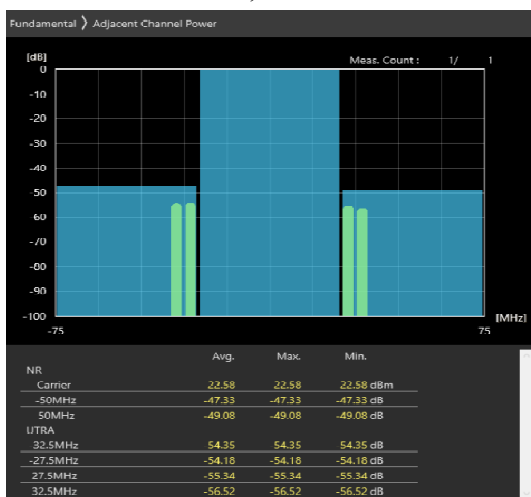
50MHz_30kHz_3675MHz-OFDM QPSK_RB1@132 -49.16,-48.48dB
