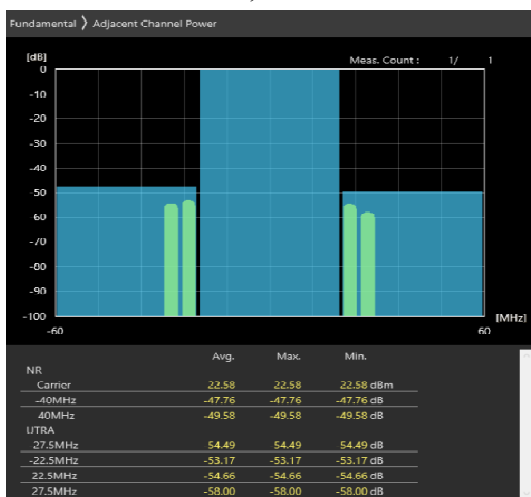
40MHz_30kHz_3680MHz-OFDM QPSK_RB1@105 -49.62,-48.39dB
