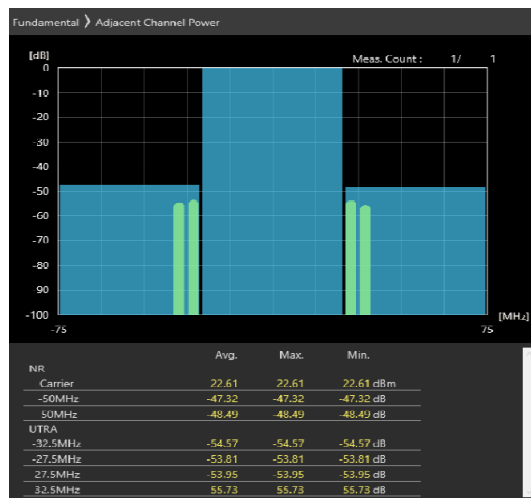
50MHz_30kHz_3675MHz-OFDM QPSK_RB64@32 -47.32,-48.49dB
