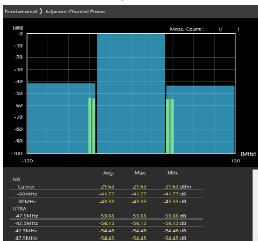
80MHz_30kHz_3660MHz-OFDM QPSK_RB1@216 -47.15,-47.28dB
