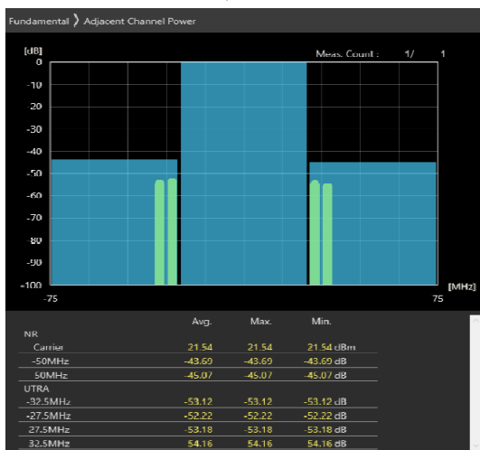
50MHz_30kHz_3575MHz-OFDM QPSK_RB64@32 -47.33,-49.08dB
