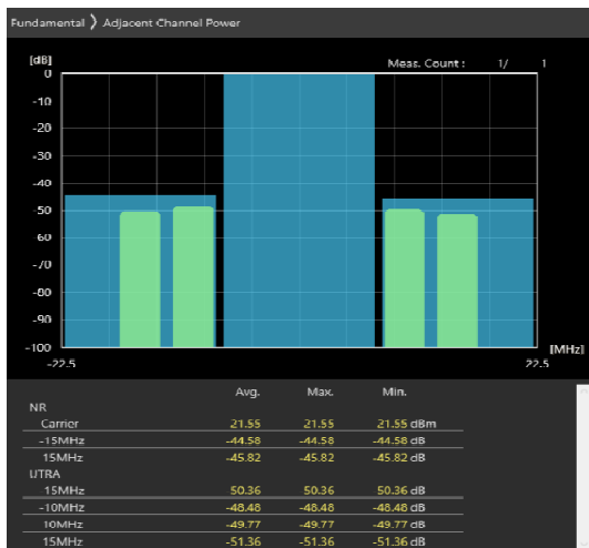
15MHz_30kHz_3692.5MHz-OFDM QPSK_RB1@37 -52.57,-49.81dB
