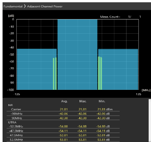
90MHz_30kHz_3655MHz-OFDM QPSK_RB243@0 -42.06,-42.3dB
