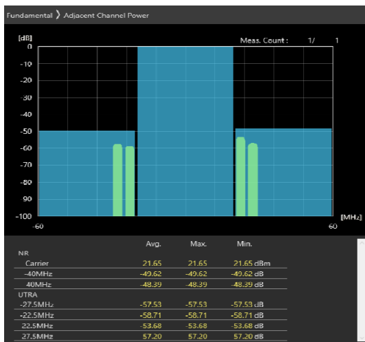
40MHz_30kHz_3680MHz-OFDM QPSK_RB1@105 -49.62,-48.39dB
