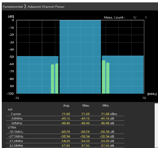
50MHz_30kHz_3675MHz-OFDM QPSK_RB1@132 -49.16,-48.48dB
