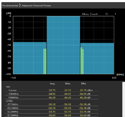
100MHz_30kHz_3600MHz-OFDM QPSK_RB270@0 -40.83,-43.42dB
