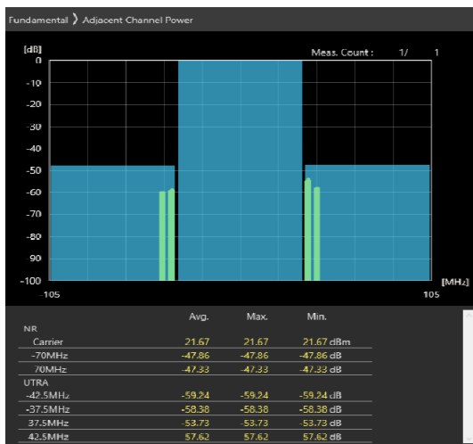
70MHz_30kHz_3665MHz-OFDM QPSK_RB1@188 -47.86,-47.33dB
