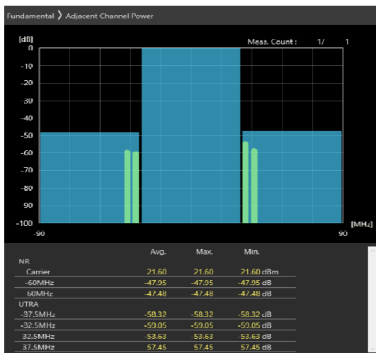
60MHz_30kHz_3670MHz-OFDM QPSK_RB1@161 -47.95,-47.48dB
