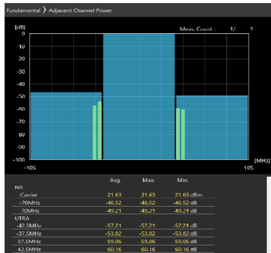
70MHz_30kHz_3665MHz-OFDM QPSK_RB180@0 -42.74,-42.08dB
