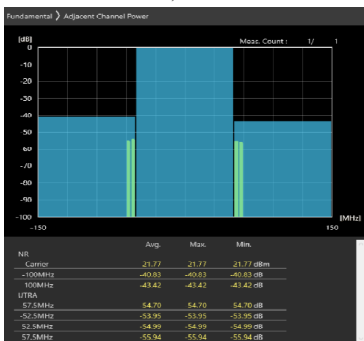
100MHz_30kHz_3650MHz-OFDM QPSK_RB1@272 -46.42,-46.75dB
