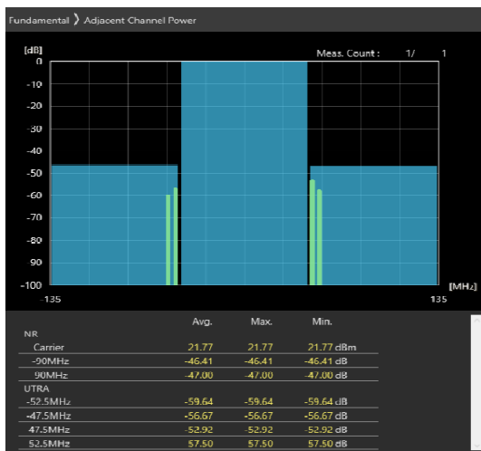
90MHz_30kHz_3655MHz-OFDM QPSK_RB1@244 -46.41,-47dB
