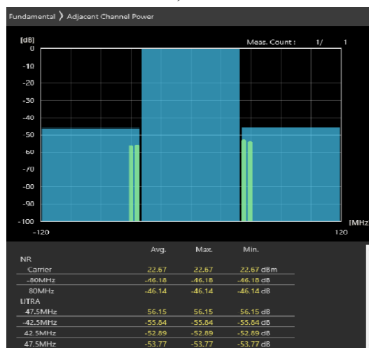
80MHz_30kHz_3660MHz-OFDM QPSK_RB216@0 -42.68,-41.73dB
