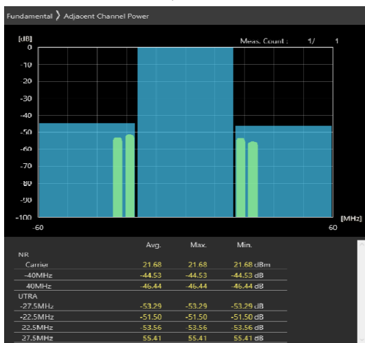
40MHz_30kHz_3570MHz-OFDM QPSK_RB50@25 -47.76,-49.58dB
