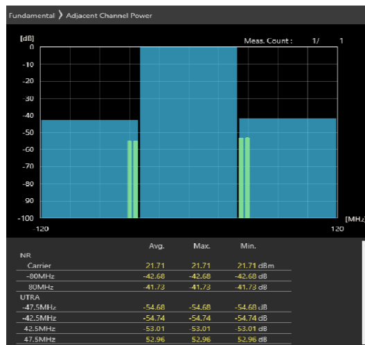
80MHz_30kHz_3660MHz-OFDM QPSK_RB216@0 -42.68,-41.73dB
