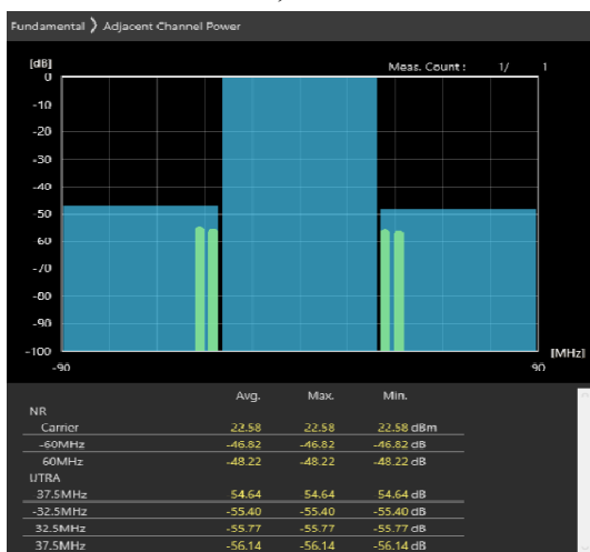
60MHz_30kHz_3670MHz-OFDM QPSK_RB1@161 -47.95,-47.48dB
