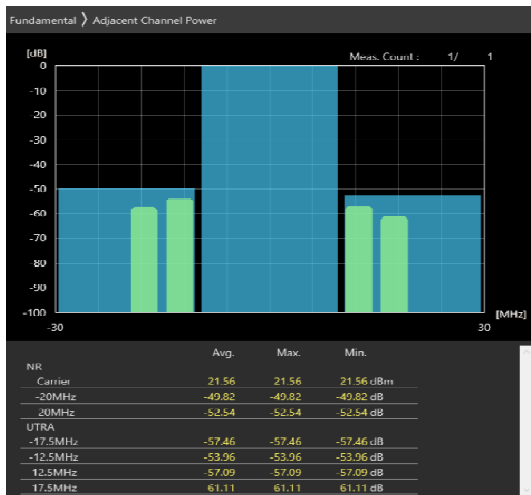
20MHz_30kHz_3560MHz-OFDM QPSK_RB50@0 -44.82,-45.86dB
