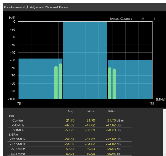
50MHz_30kHz_3675MHz-OFDM QPSK_RB128@0 -44.34,-43.02dB
