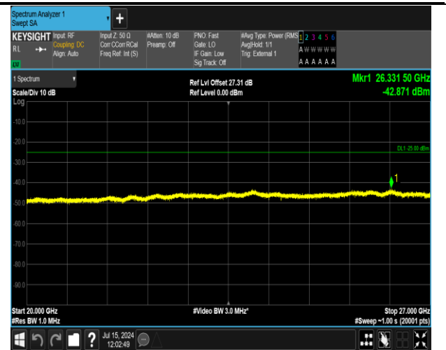
41(2555-2655)-41(2555-2655)-20MHz-5MHz-16QAM-16Q AM-40340-40457-100RB#0-25RB#0-20000~27000MHz-PA SS
