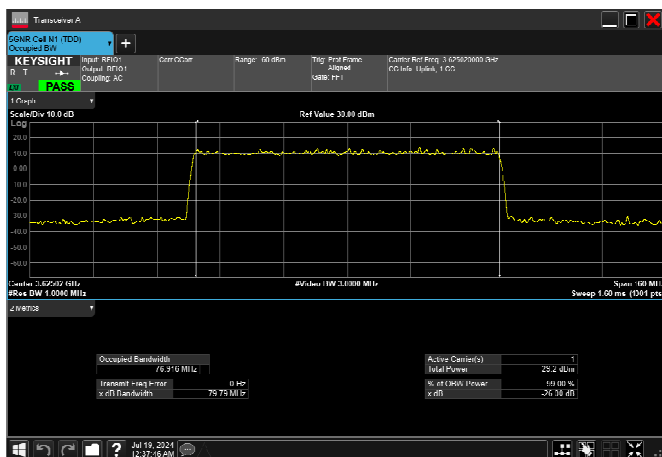
n78_2_80MHz_30kHz_3625MHz_DFT-s-OFDM QPSK_RB216@0 76.916MHz
