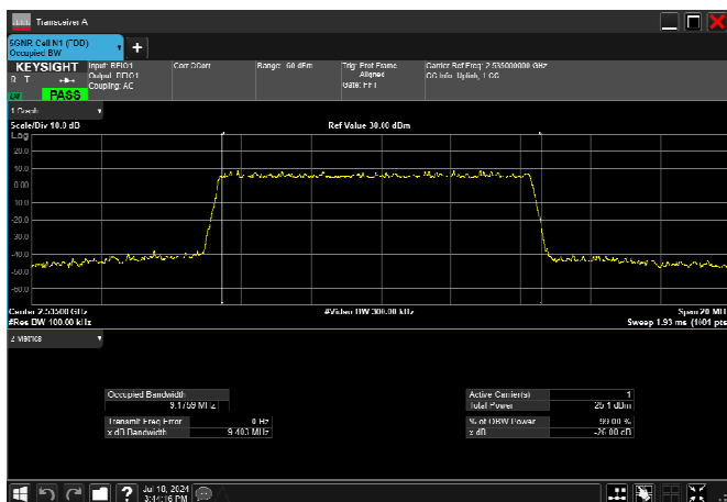
n7_10MHz_15kHz_2535MHz_DFT-s-OFDM QPSK_RB50@0 9.176MHz
