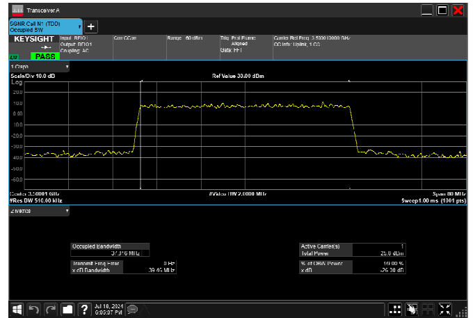
n77_1_50MHz_30kHz_3500MHz_DFT-s-OFDM \pi/2 BPSK_RB128@0 46.898MHz
