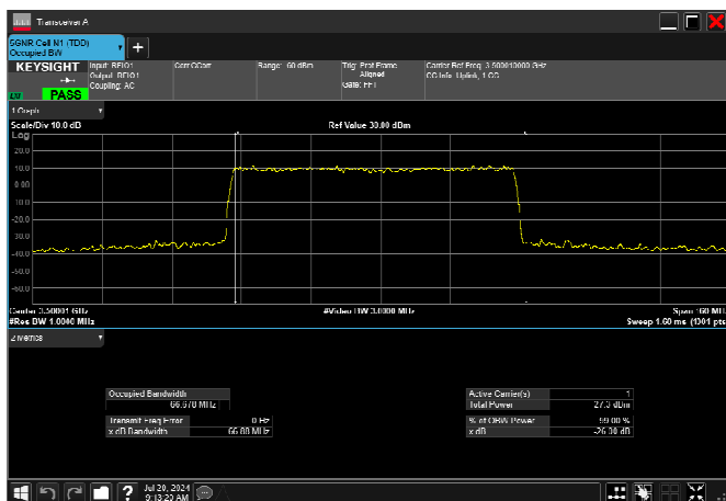
n77_1_70MHz_30kHz_3500MHz_DFT-s-OFDM QPSK_RB180@0 66.678MHz
