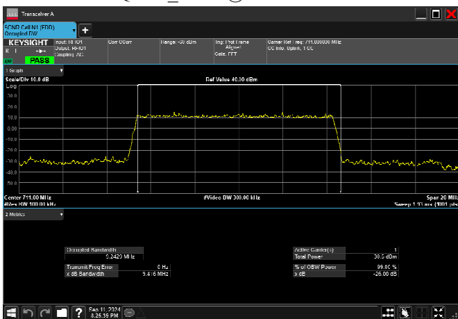
n12_10MHz_15kHz_711MHz_DFT-s-OFDM QPSK_RB50@0 9.243MHz
