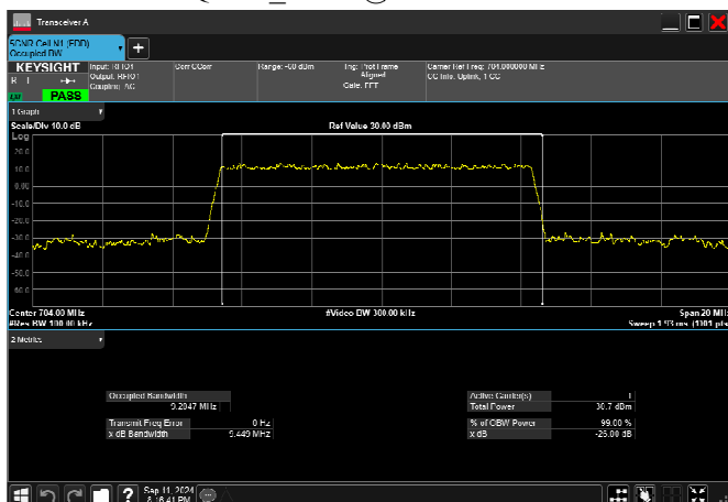
n12_10MHz_15kHz_704MHz_DFT-s-OFDM QPSK_RB50@0 9.205MHz
