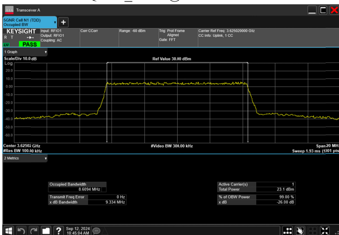
n77_2_10MHz_30kHz_3625MHz_DFT-s-OFDM QPSK_RB24@0 8.609MHz
