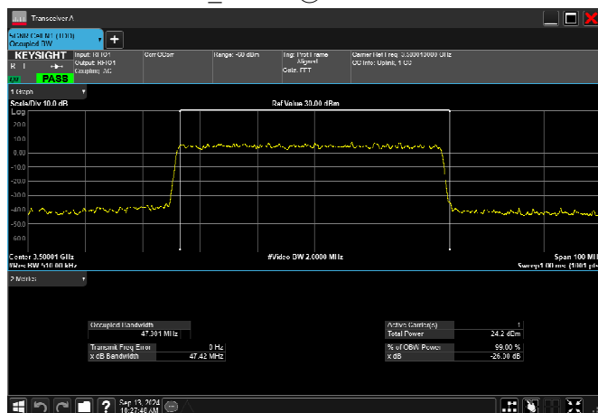
n78_1_50MHz_30kHz_3500MHz_DFT-s-OFDM 16 QAM RB128@0 47.010MHz
