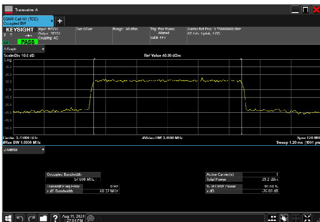
n78_3_60MHz_30kHz_3750MHz_CP-OFDM 64 QAM_RB162@0 57.698MHz
