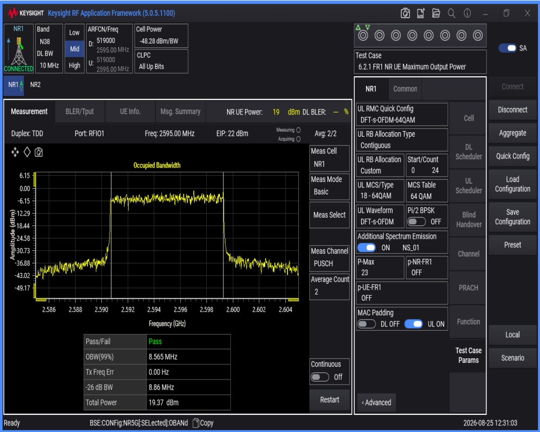
n38 SCS=30kHz DFT_QAM256 BW=10MHz Channel=519000 RB=24@0
