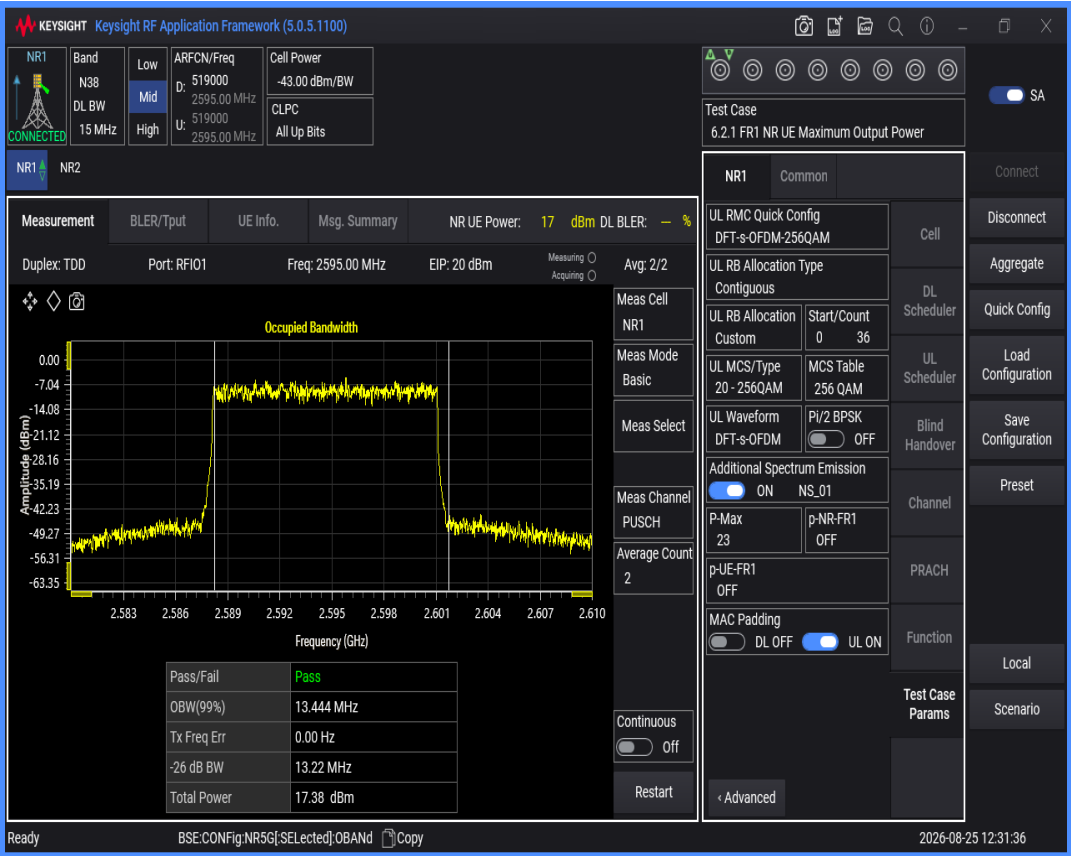
n38 SCS=30kHz DFT_BPSK BW=20MHz Channel=519000 RB=50@0
