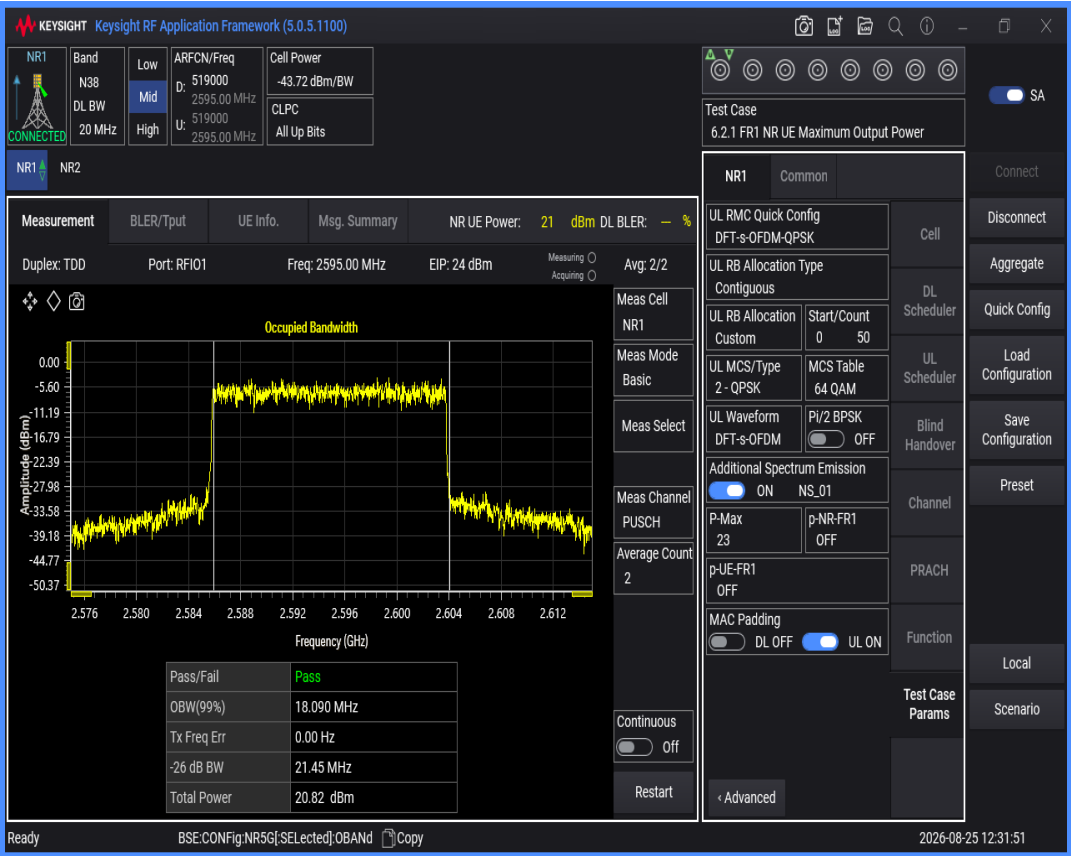
n38 SCS=30kHz DFT_QAM16 BW=20MHz Channel=519000 RB=50@0
