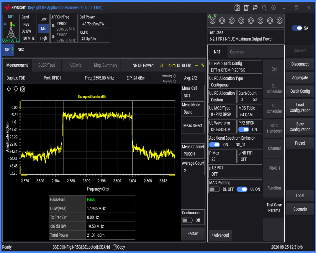
n38 SCS=30kHz DFT_QPSK BW=20MHz Channel=519000 RB=50@0
