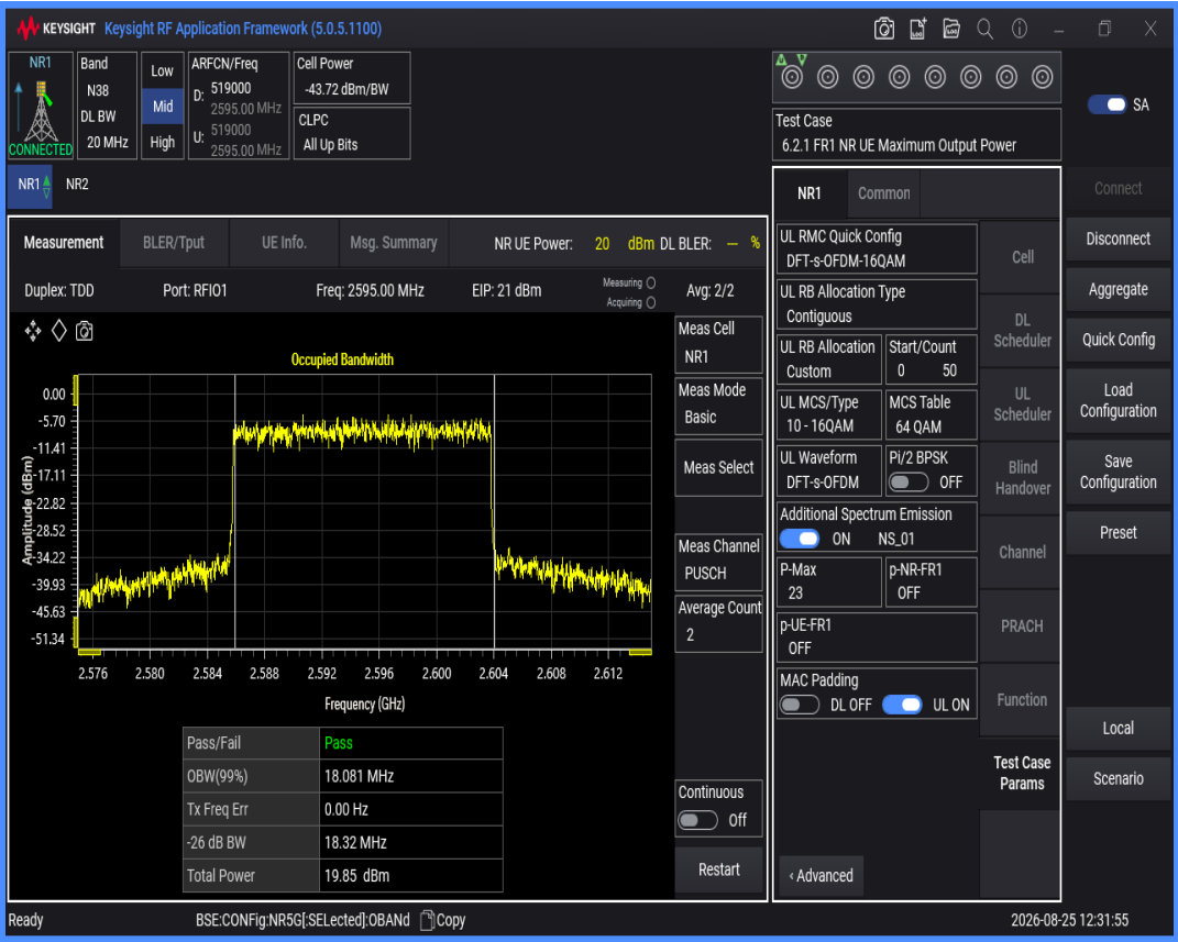
n38 SCS=30kHz DFT_QAM64 BW=20MHz Channel=519000 RB=50@0
