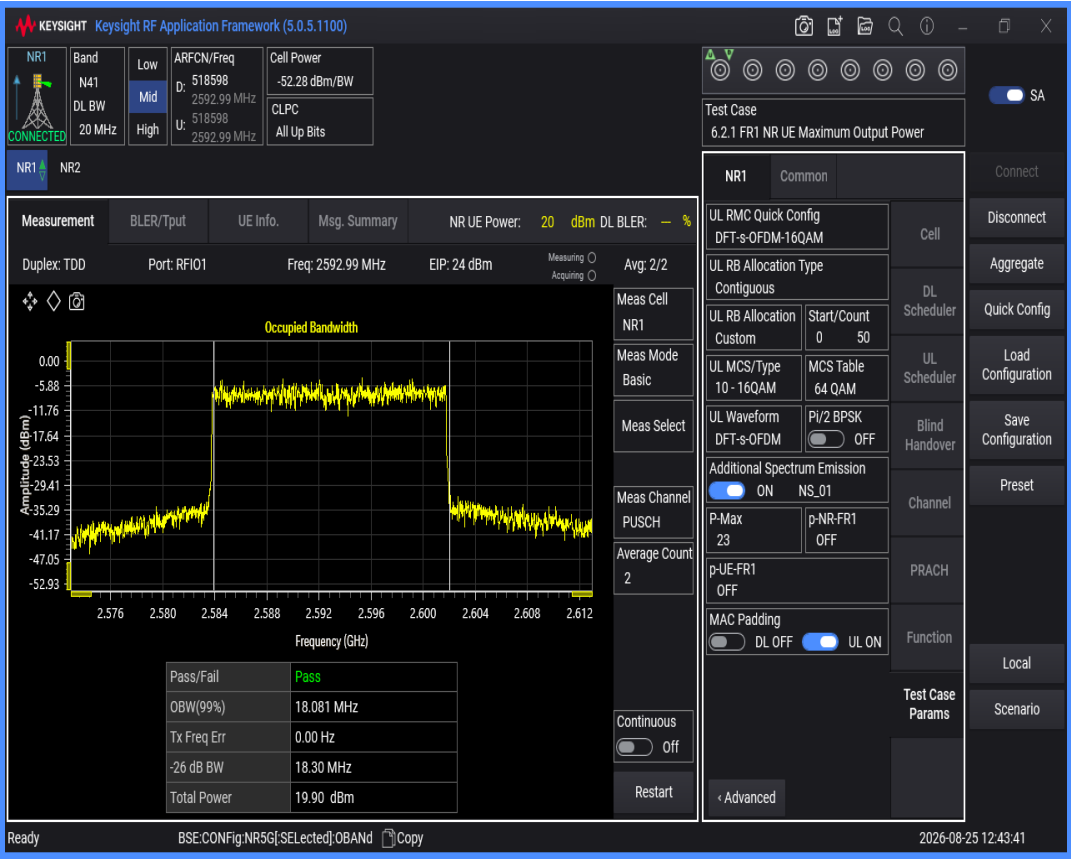
n41 SCS=30kHz DFT_QAM64 BW=20MHz Channel=518598 RB=50@0
