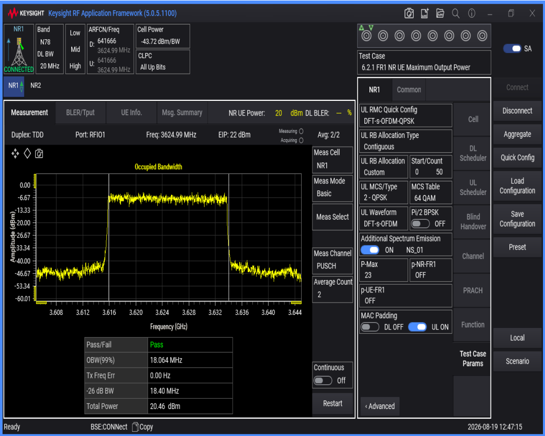
n78(3550-3700) SCS=30kHz DFT_QAM16 BW=20MHz Channel=641666 RB=50@0
