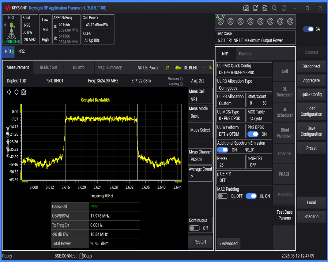
n78(3550-3700) SCS=30kHz DFT_QPSK BW=20MHz Channel=641666 RB=50@0
