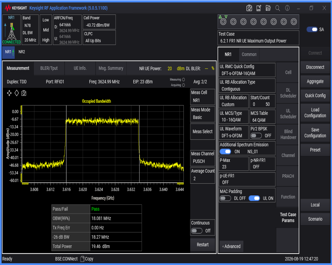
n78(3550-3700) SCS=30kHz DFT_QAM64 BW=20MHz Channel=641666 RB=50@0
