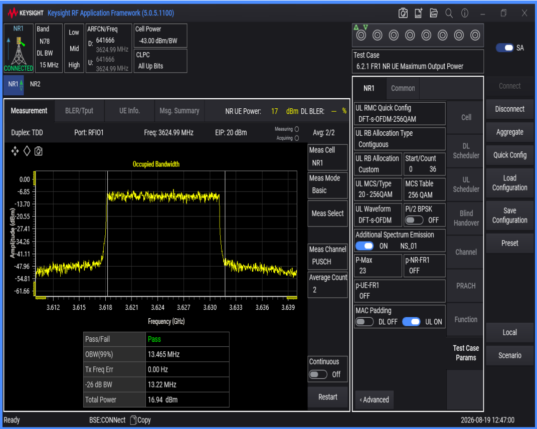
n78(3550-3700) SCS=30kHz DFT_BPSK BW=20MHz Channel=641666 RB=50@0
