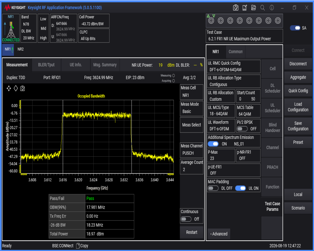
n78(3550-3700) SCS=30kHz DFT_QAM256 BW=20MHz Channel=641666 RB=50@0
