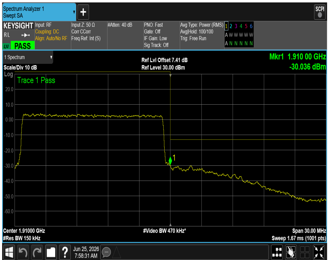
Band2 QPSK BW=20MHz Channel=18700 RB Size=100 Position=#0
