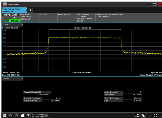
30MHz_30kHz_2674.98MHz_CP-OFDM QPSK_RB78@0&amp;27.808 MHz
