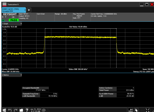
80MHz_30kHz_2649.99MHz_DFT-s-OFDM PI/2 BPSK_RB216@0&amp;77.017 MHz
