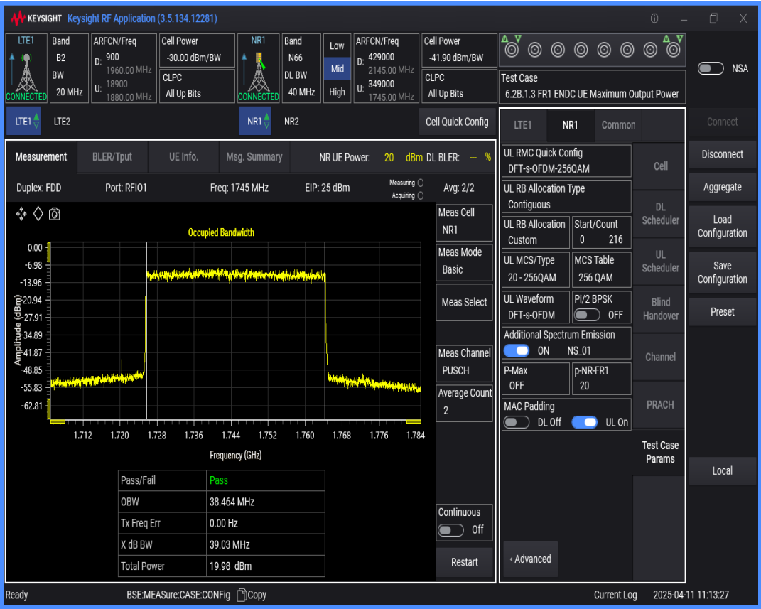
n66 SCS=15kHz DFT_QAM256 BW=20MHz Channel=349000 RB=100@0
