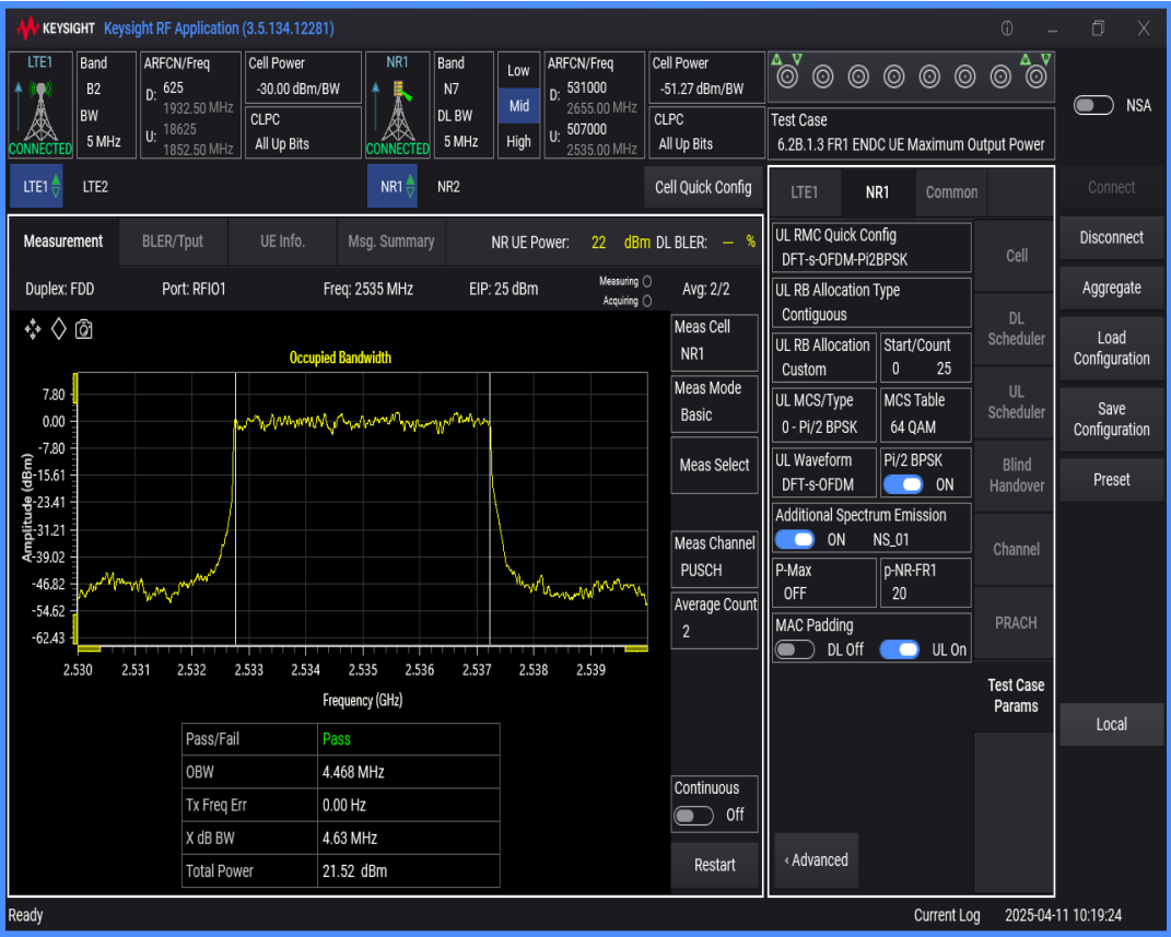
n7 SCS=15kHz DFT_BPSK BW=20MHz Channel=507000 RB=100@0
