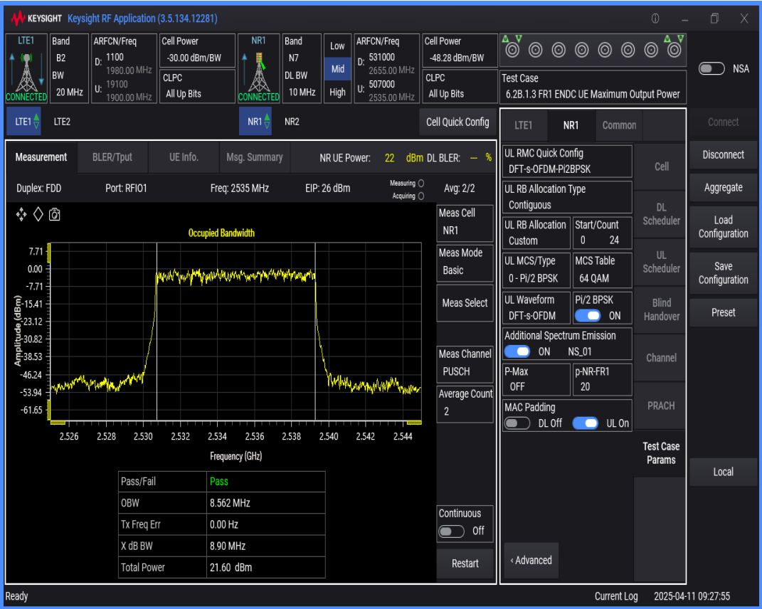
n7 SCS=15kHz DFT_QPSK BW=15MHz Channel=507000 RB=75@0
