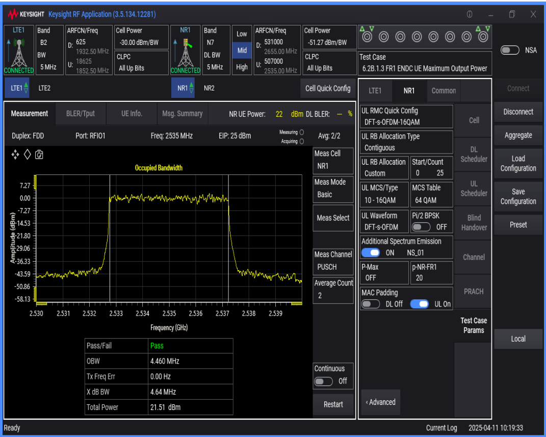
n7 SCS=15kHz DFT_QAM16 BW=10MHz Channel=507000 RB=50@0
