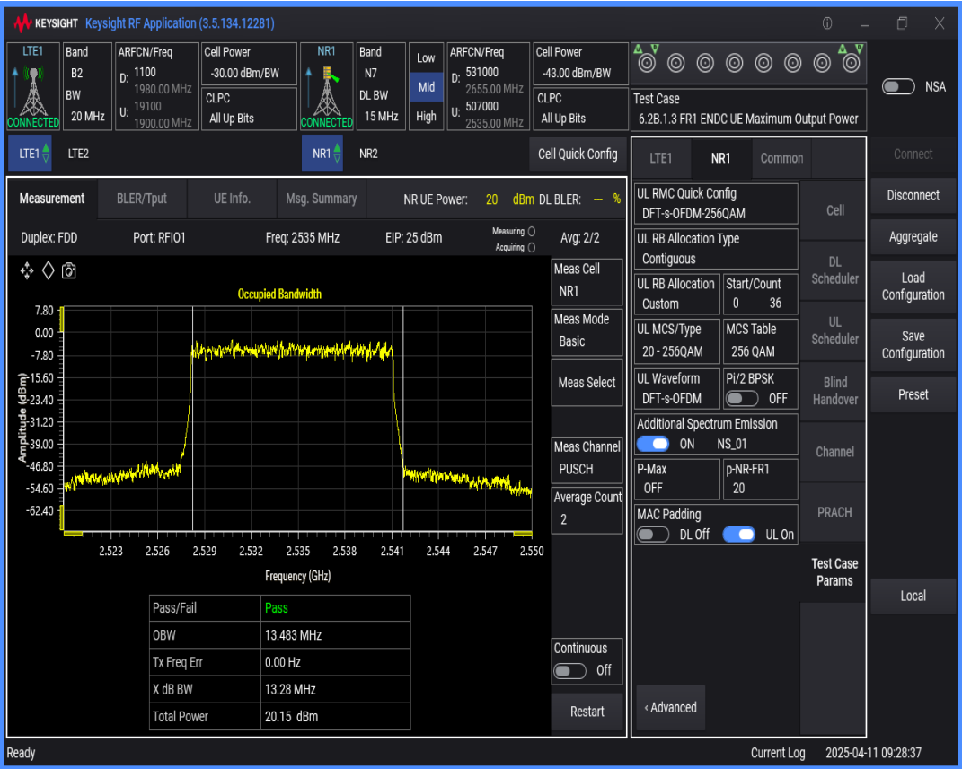
n7 SCS=30kHz DFT_BPSK BW=20MHz Channel=507000 RB=50@0
