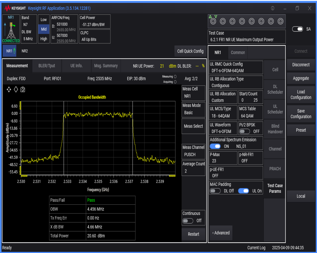
n7 SCS=15kHz DFT_QPSK BW=10MHz Channel=507000 RB=50@0
