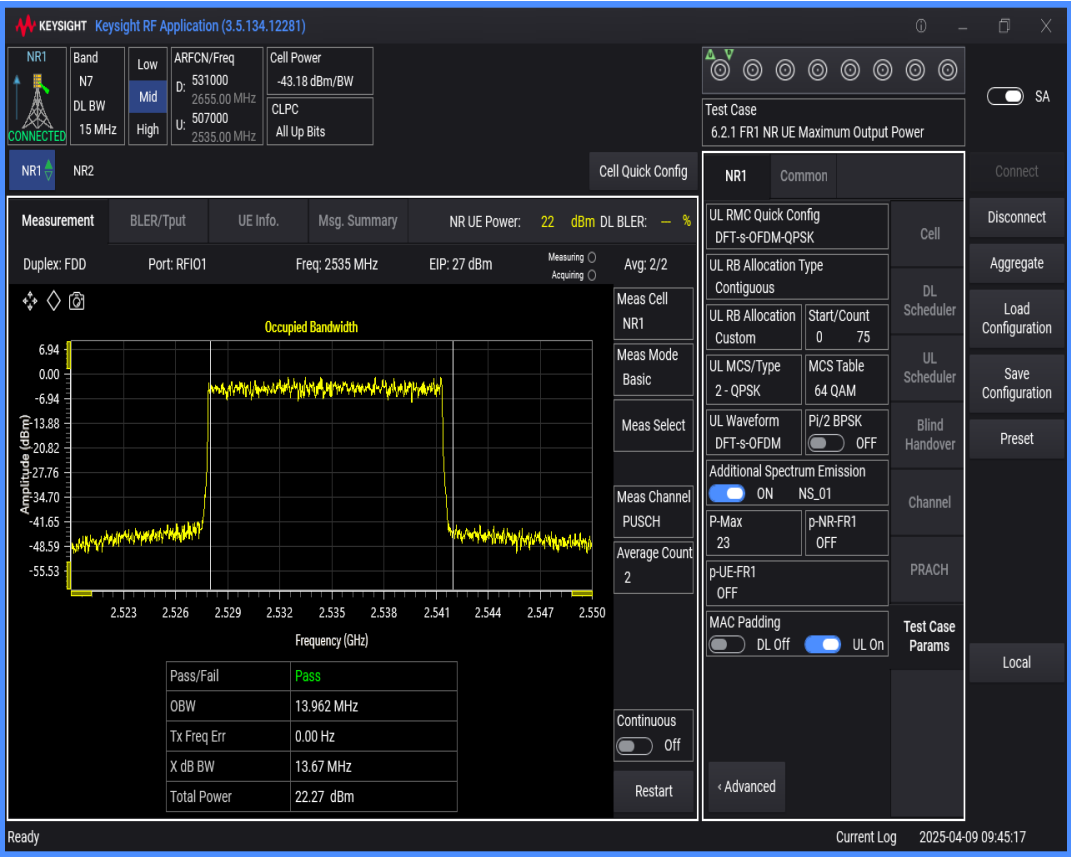
n7 SCS=15kHz DFT_QPSK BW=20MHz Channel=507000 RB=100@0
