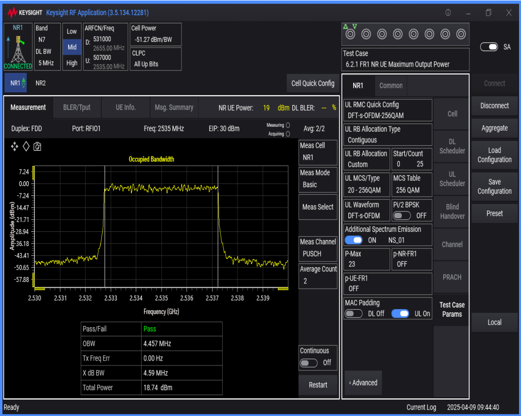
n7 SCS=15kHz DFT_QAM256 BW=20MHz Channel=507000 RB=100@0
