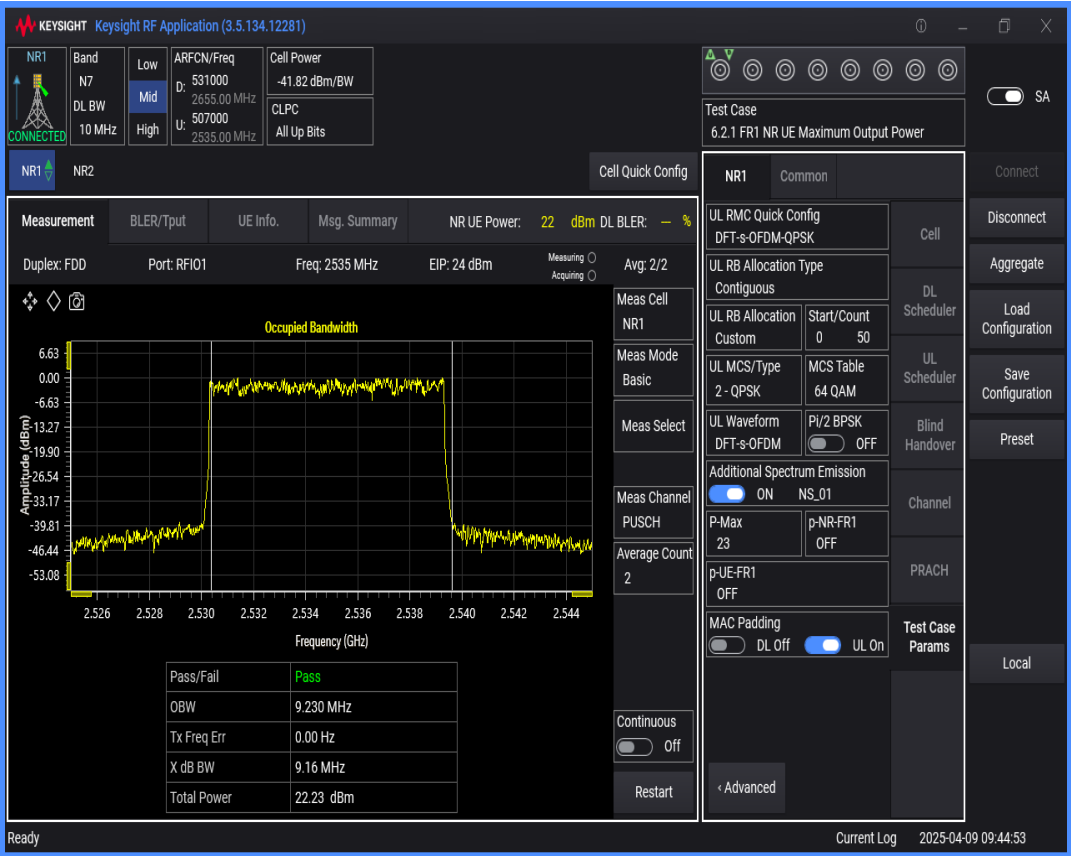
n7 SCS=15kHz DFT_QPSK BW=15MHz Channel=507000 RB=75@0
