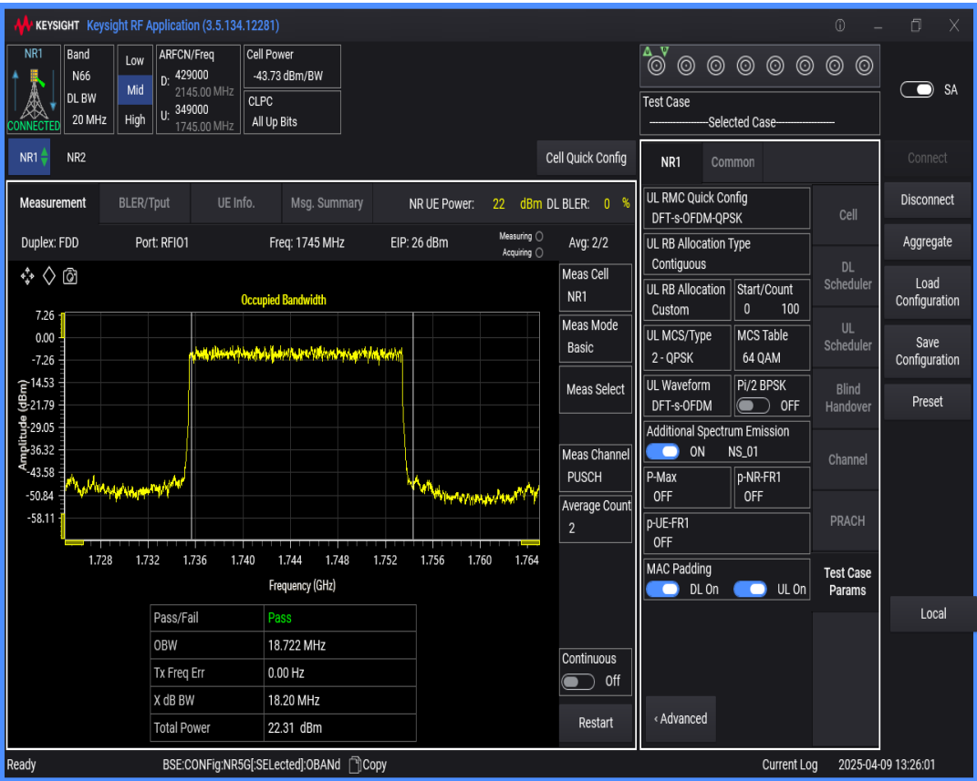
n66 SCS=15kHz DFT_QPSK BW=5MHz Channel=349000 RB=25@0
