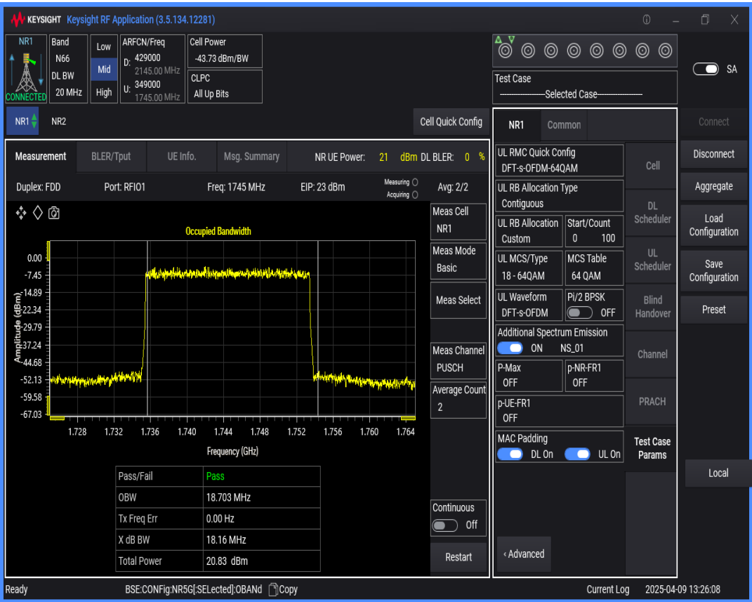
n66 SCS=15kHz DFT_QPSK BW=10MHz Channel=349000 RB=50@0
