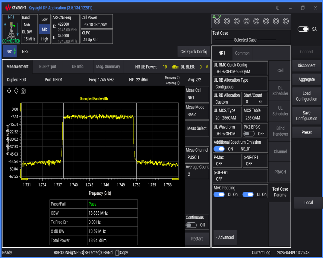
n66 SCS=15kHz DFT_QAM256 BW=10MHz Channel=349000 RB=50@0
