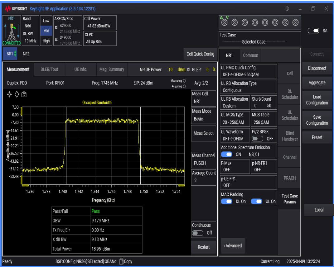
n66 SCS=15kHz DFT_QAM256 BW=20MHz Channel=349000 RB=100@0
