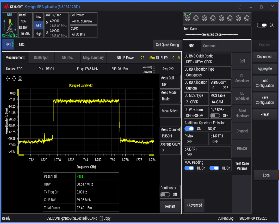
n66 SCS=15kHz DFT_QPSK BW=20MHz Channel=349000 RB=100@0
