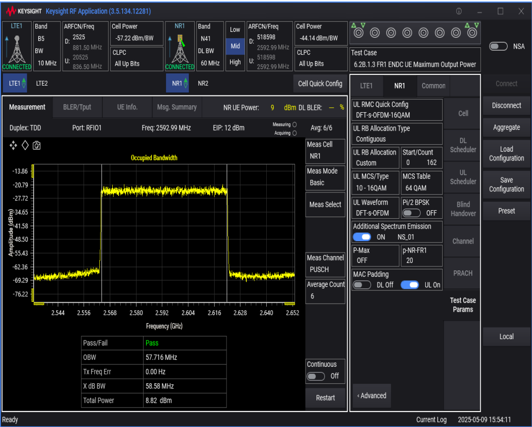
n41 SCS=30kHz DFT_QAM16 BW=20MHz Channel=518598 RB=50@0
