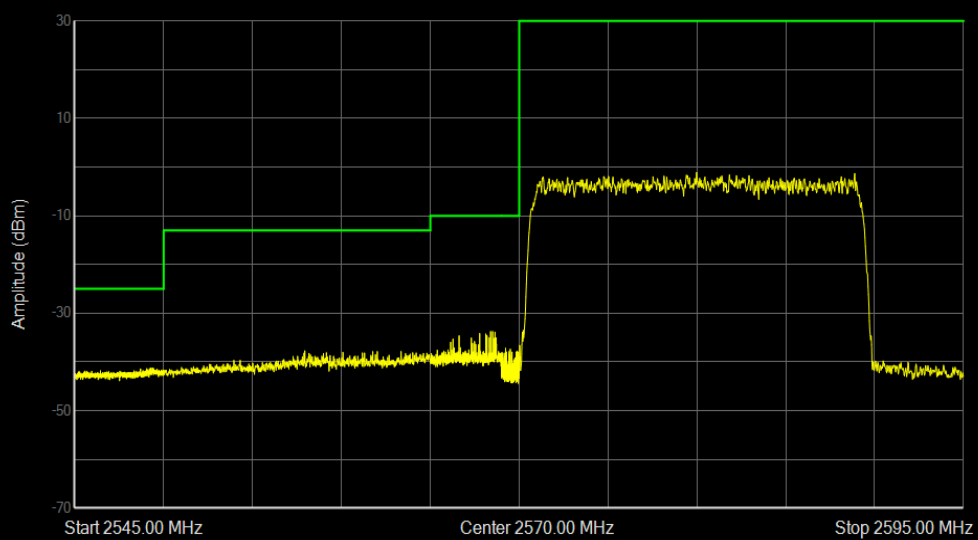
n38 SCS=30kHz CP_QPSK BW=20MHz Channel=516000 RB=51@0
