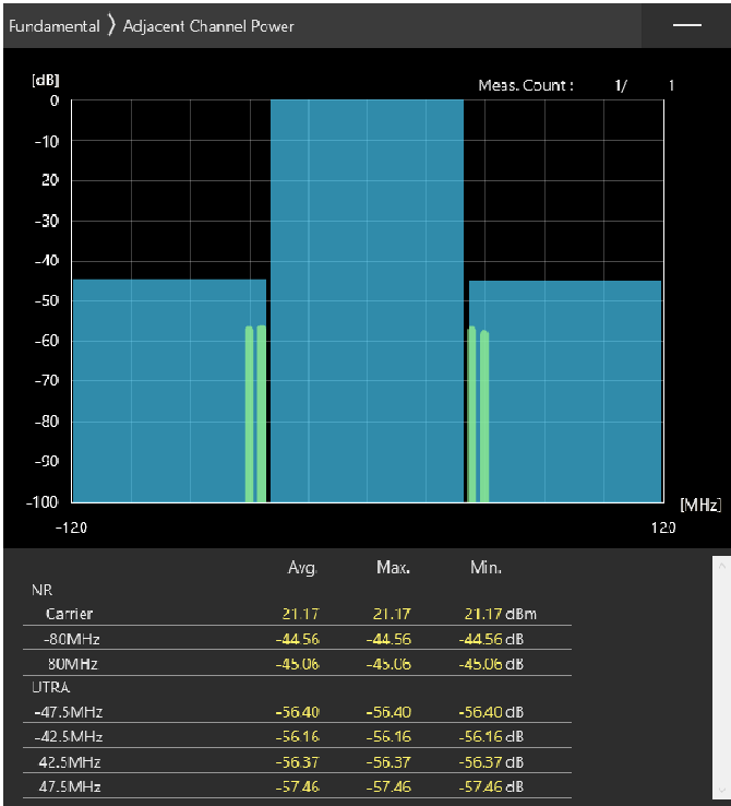
80MHz_30kHz_3660MHz-OFDM QPSK_RB216@0 -44.56,-45.06dB
