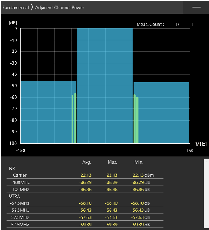
100MHz_30kHz_3650MHz-OFDM QPSK_RB135@67 -46.29,-46.86dB
