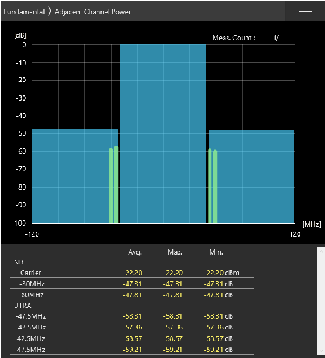
80MHz_30kHz_3660MHz-OFDM QPSK_RB108@54 -47.31,-47.81dB
