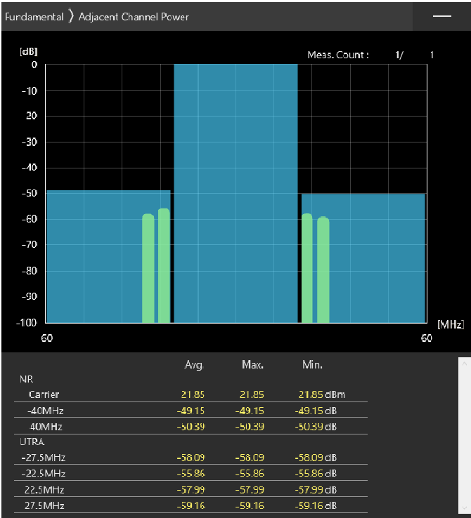
40MHz_30kHz_3570MHz-OFDM QPSK_RB50@25 -49.15,-50.39dB
