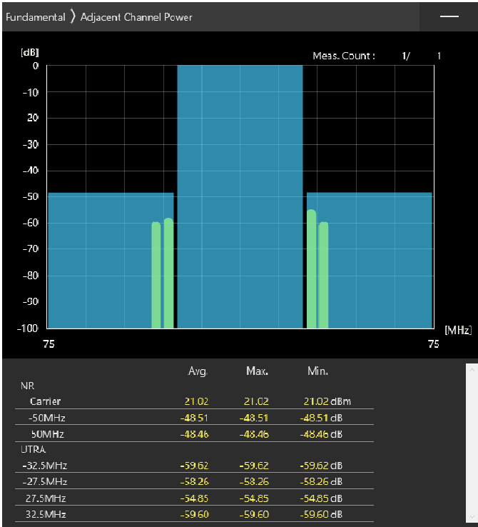
50MHz_30kHz_3675MHz-OFDM QPSK_RB1@132 -48.51,-48.46dB
