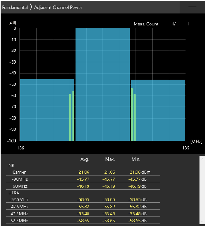
90MHz_30kHz_3655MHz-OFDM QPSK_RB1@244 -45.77,-46.19dB
