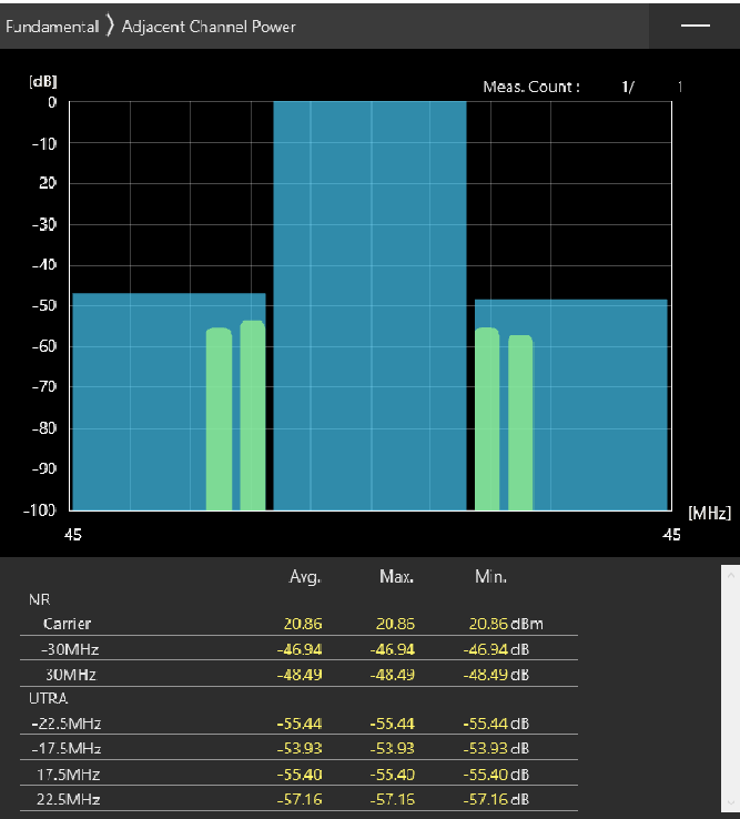
30MHz_30kHz_3565MHz-OFDM QPSK_RB75@0 -46.94,-48.49dB
