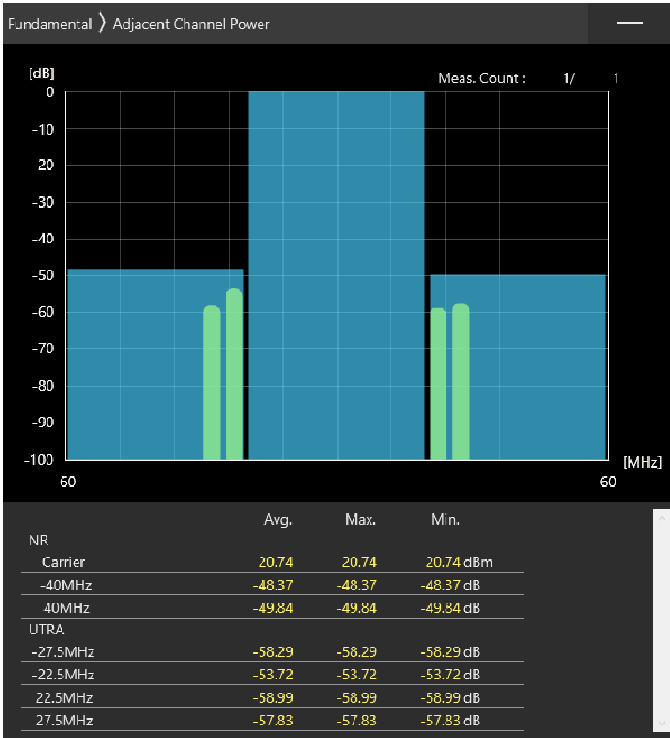
40MHz_30kHz_3570MHz-OFDM QPSK_RB1@0 -48.37,-49.84dB
