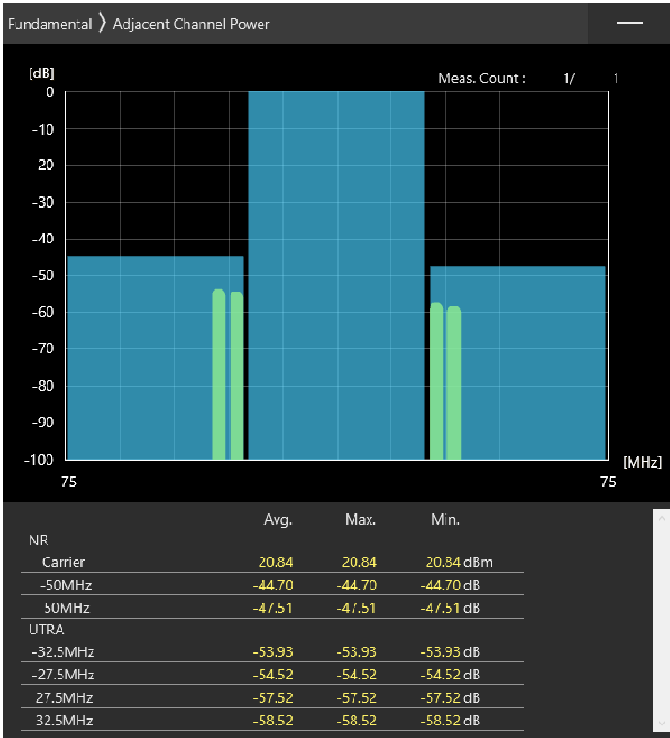
50MHz_30kHz_3575MHz-OFDM QPSK_RB128@0 -44.7,-47.51dB
