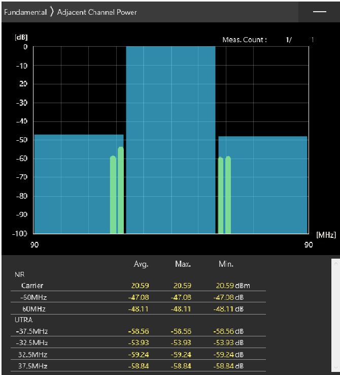
60MHz_30kHz_3580MHz-OFDM QPSK_RB1@0 -47.08,-48.11dB
