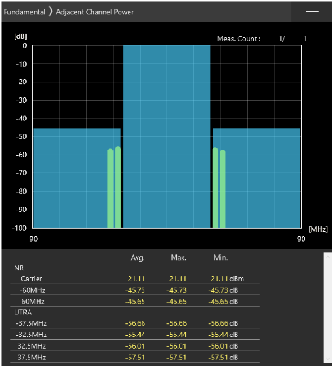
60MHz_30kHz_3670MHz-OFDM QPSK_RB162@0 -45.73,-45.65dB
