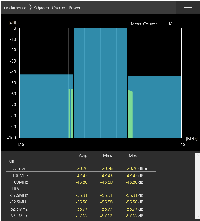
100MHz_30kHz_3650MHz-OFDM QPSK_RB270@0 -42.43,-43.8dB
