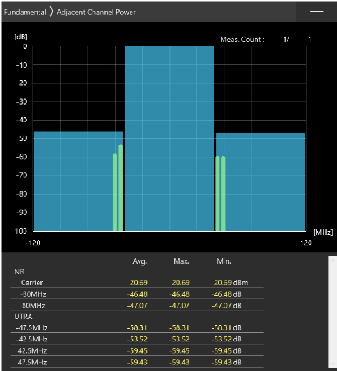
80MHz_30kHz_3590MHz-OFDM QPSK_RB1@0 -46.48,-47.07dB
