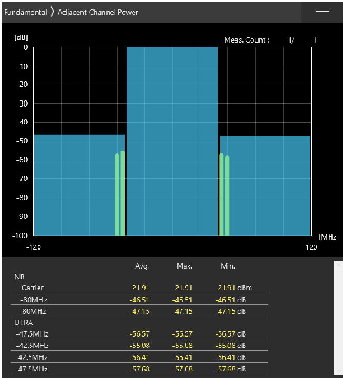
80MHz_30kHz_3590MHz-OFDM QPSK_RB108@54 -46.51,-47.15dB
