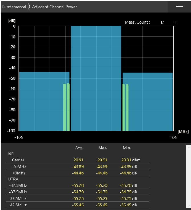
70MHz_30kHz_3585MHz-OFDM QPSK_RB180@0 -43.89,-44.46dB
