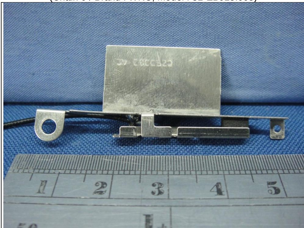
Antenna set 1 (Chain 0 / Brand : WNC, Model : 81-EBJ15.005)
