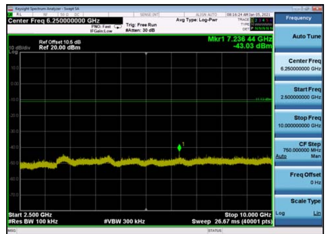
,Plot 4,2500MHz~10000MHz-802.11b ,2462MHz
