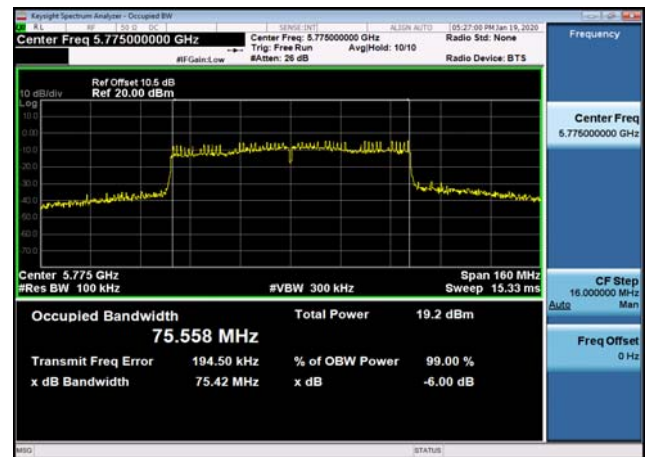
U-NII-3 6dB Bandwidth-802.11ac(80MHz) ,5775MHz
