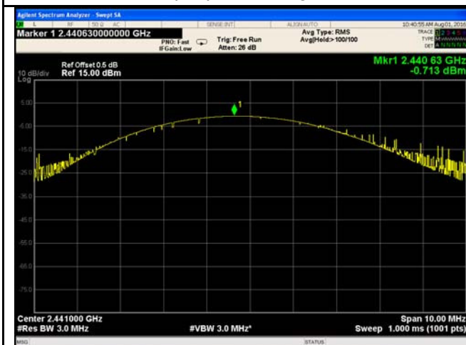
\pi/4 DQPSK Output power - Mid CH 2441
