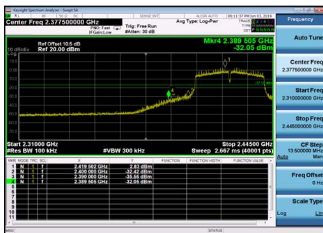
,Plot 2,Band Edge-802.11n(HT40) ,2452MHz
