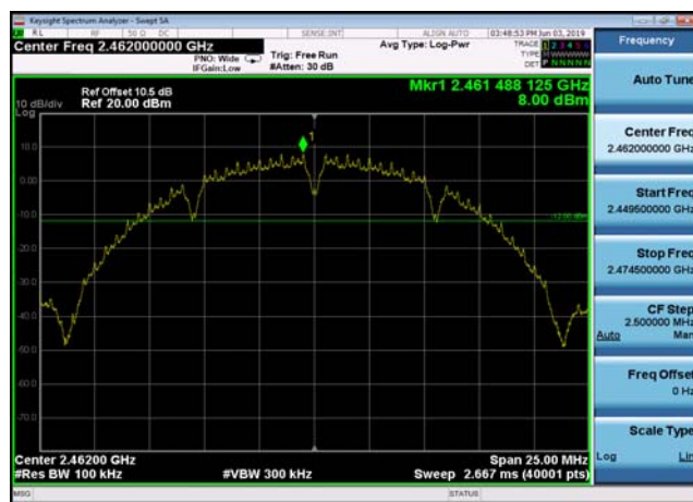
,Plot 2,Band Edge-802.11b,2437MHz
