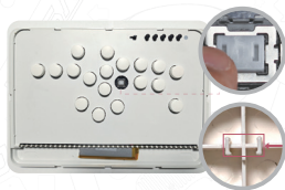
步骤1: ①键帽底部的 L 形状对准轴的 L 槽口 ②装入键帽后用力按压键帽
