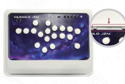
步骤2: 依次装入底图、导光板、面盖、面盖扣位对准槽口,用力按压面盖整圈,听到“咔哒”一声即可
