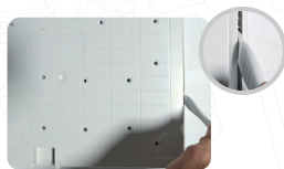
步骤2: 用撬棒工具沿着游戏控制器背面一整圈撬开面盖
