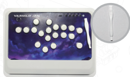
步骤1: 准备撬棒工具 (拆换前请将游戏控制器断电)
