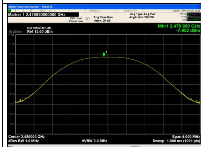
AV Output power - High CH 2480
