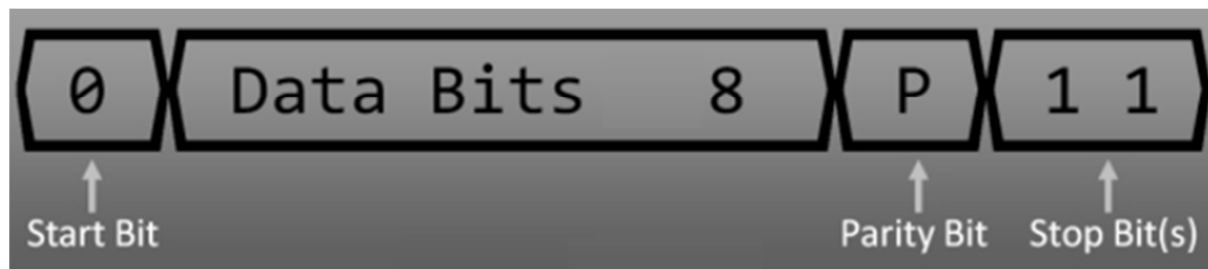
Figure10. UART Data Format
