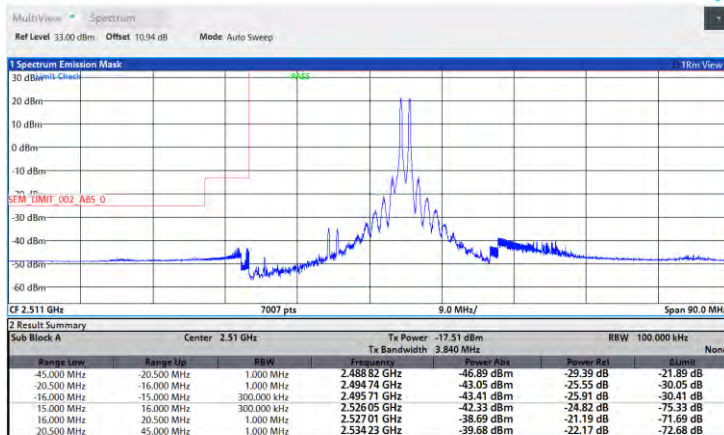
20MHz-10MHz QPSK-QPSK 41391-41535 1RB#0-1RB#49
