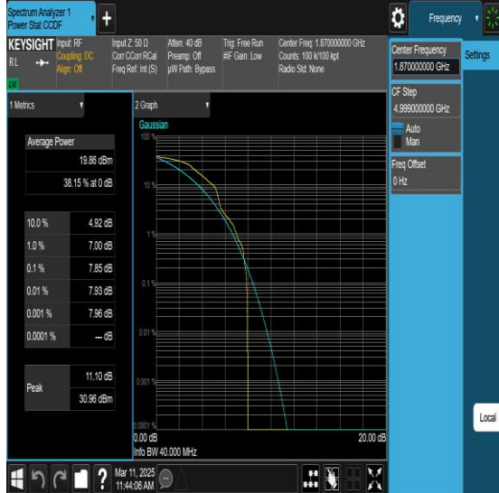
NTNV-N2-PC3-15-40-L-DFT-QPSK-Edge 1RB Left-PASS
