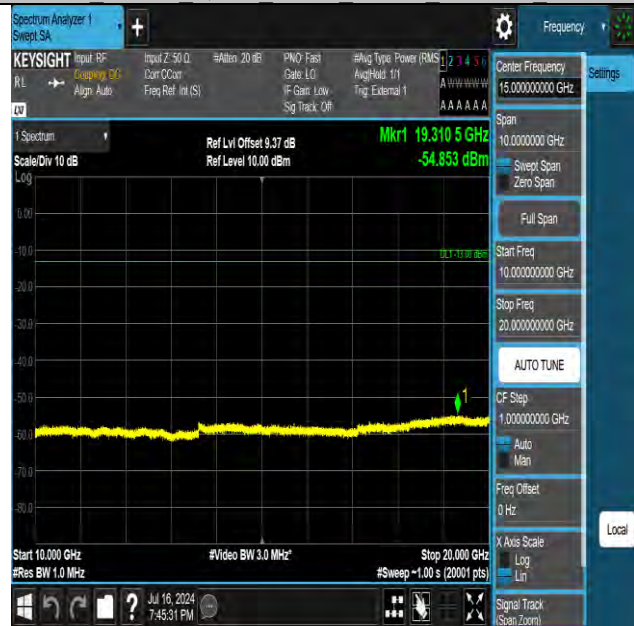
Band42 15MHz QPSK 43015 1RB#0 10000~20000 10000~20000
