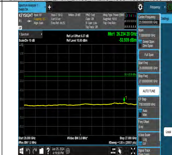
Band7 20MHz QPSK 21100 1RB#0 20000~27000 20000~27000
