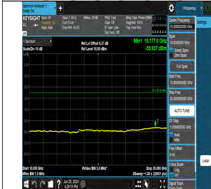
Band7 15MHz QPSK 21100 1RB#0 10000~20000 10000~20000
