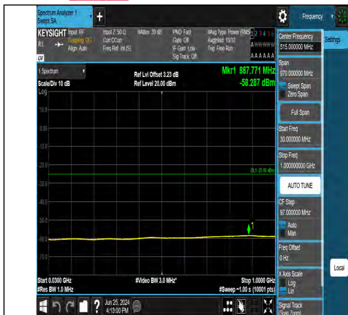
Band7 10MHz QPSK 20800 1RB#0 30~1000 30~1000
