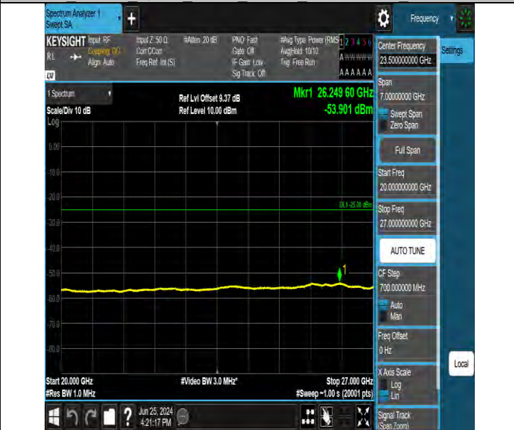
Band7 20MHz QPSK 21350 1RB#0 20000~27000 20000~27000
