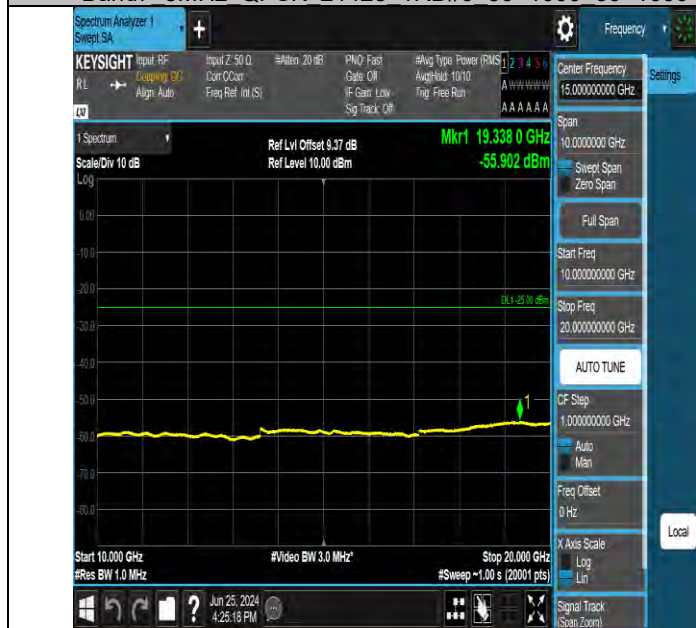
Band7 5MHz QPSK 21425 1RB#0 10000~20000 10000~20000
