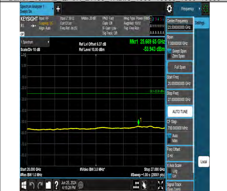
Band7 10MHz QPSK 21100 1RB#0 20000~27000 20000~27000
