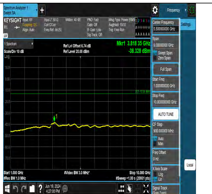
Band13 5MHz QPSK 23230 1RB#0 1000~10000 1000~10000
