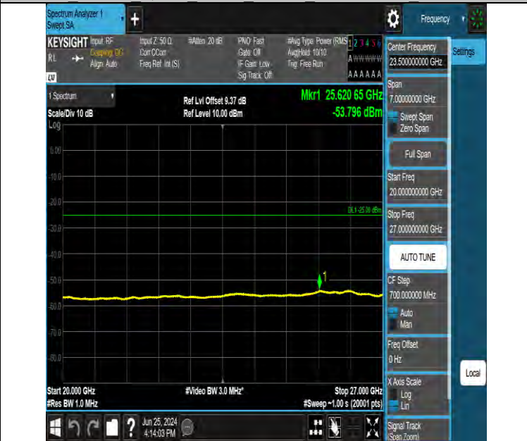
Band7 10MHz QPSK 20800 1RB#0 20000~27000 20000~27000
