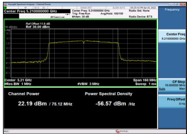
U-NII-1 Output Power-802.11n(20MHz) ,5220MHz,Ant2
