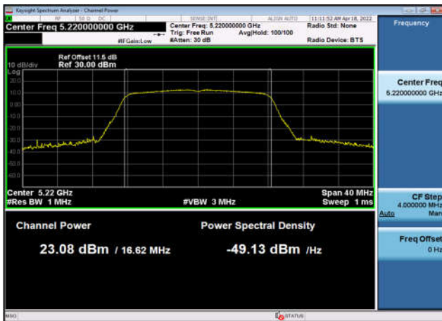
U-NII-1 Output Power-802.11ac(20MHz) ,5180MHz,Ant1
