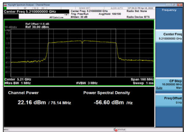
U-NII-1 Output Power-802.11ac(80MHz) ,5210MHz,Ant2
