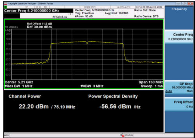
U-NII-1 Output Power-802.11ax(20MHz) ,5220MHz,Ant1
