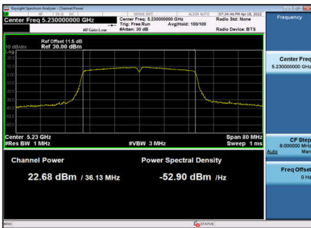
U-NII-1 Output Power-802.11ac(40MHz) ,5230MHz,Ant2
