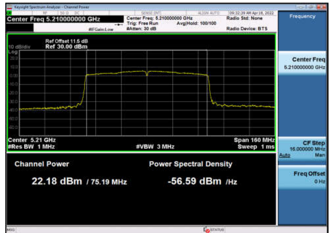
U-NII-1 Output Power-802.11n(20MHz) ,5220MHz,Ant1
