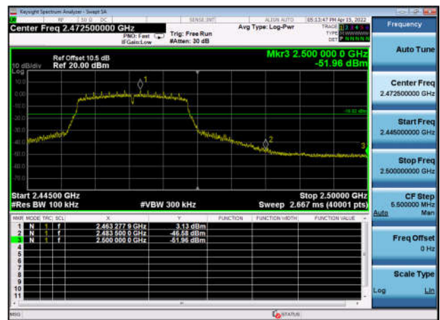
,Plot 2,Band Edge-802.11n(HT20) ,2462MHz,Ant0
