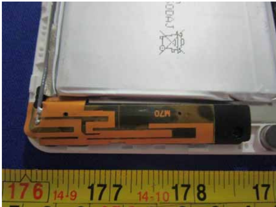
EUT –GSM & WCDMA Antenna View
