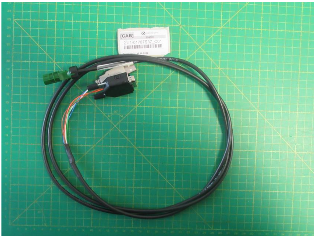
Fig. Ext.: 6 : Ext. - Front USB/CAN cable
