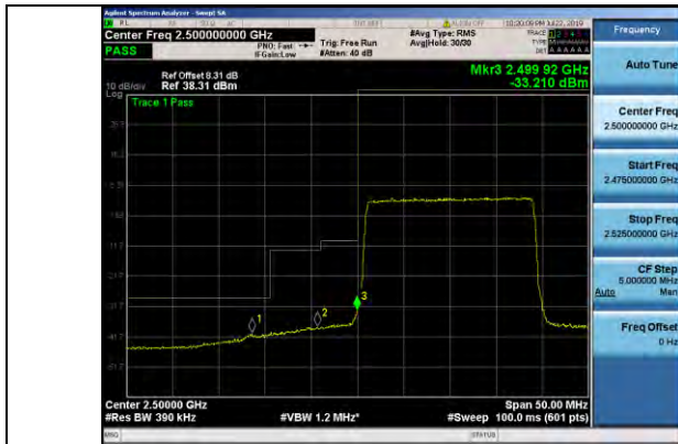
Band7 20MHz 16QAM 21350 1RB#99
