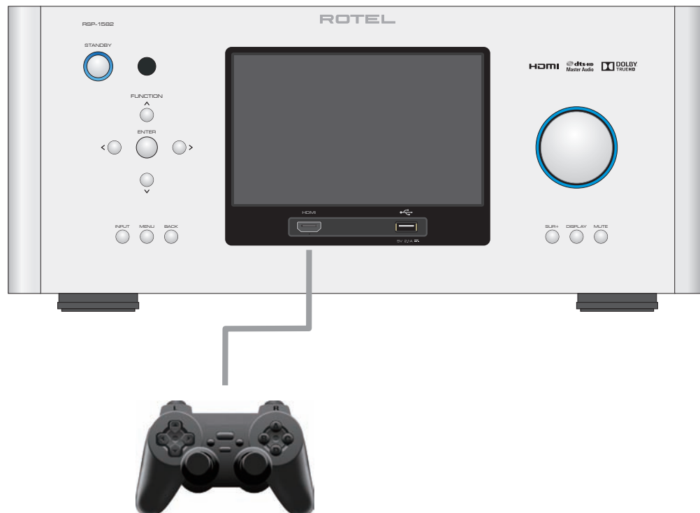
Figure 10: Front HDMI Connections Connexions HDMI avant Vorderseite HDMI-Verbindungen Conexiones HDMI del Panel Frente
