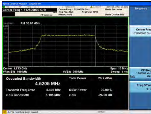
Band66 / 5MHz / Low CH / 64QAM
