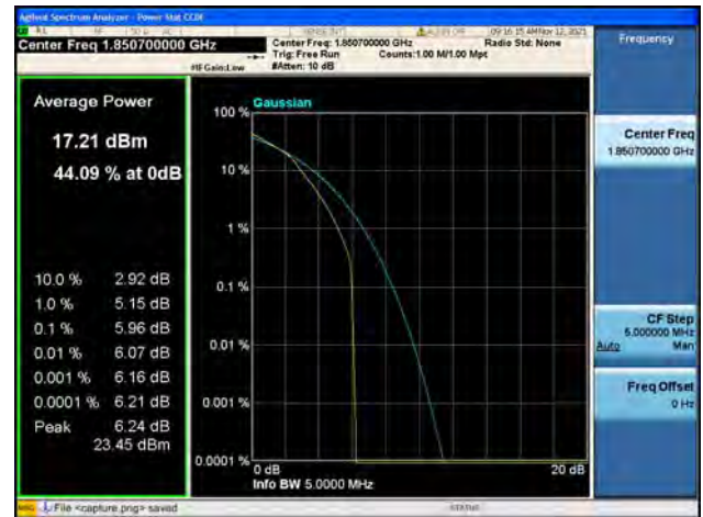
Band2 / 1.4MHz / Mid CH / QPSK
