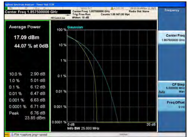
Band2 / 15MHz / Mid CH / QPSK
