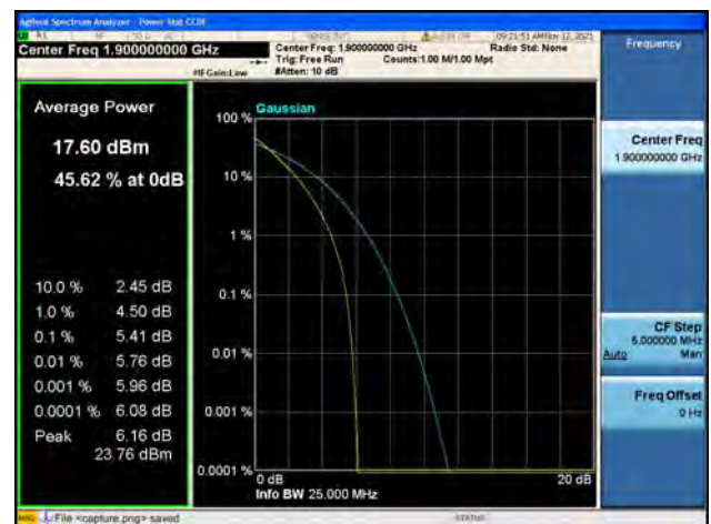
Band2 / 20MHz / High CH / 64QAM
