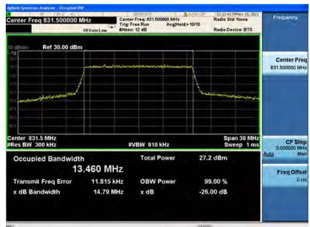
Band26 / 15MHz / Mid CH / QPSK
