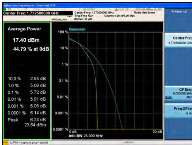
Band66 / 20MHz / Low CH / 16QAM
