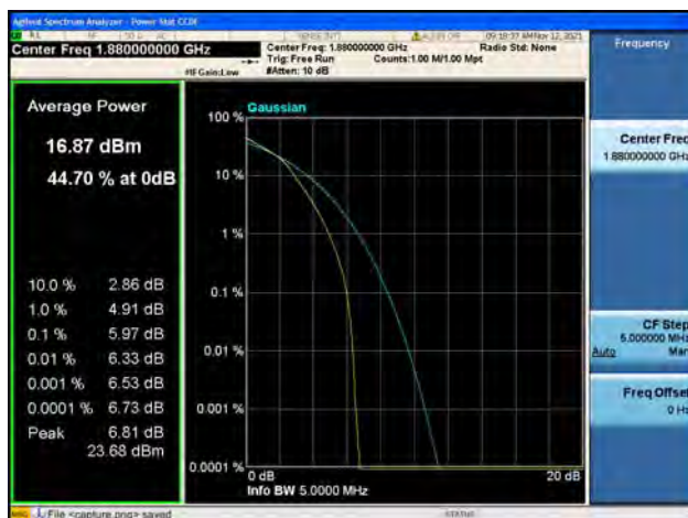
Band2 / 5MHz / Mid CH / 16QAM
