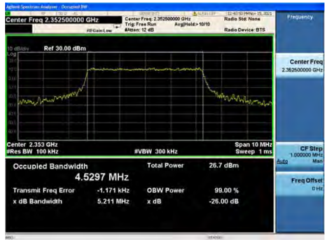
Band40/ Block B / 5MHz / Mid CH / QPSK
