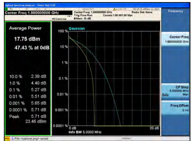
Band2 / 5MHz / Mid CH / 64QAM
