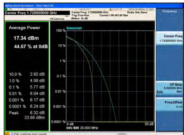
Band66 / 20MHz / Low CH / 64QAM
