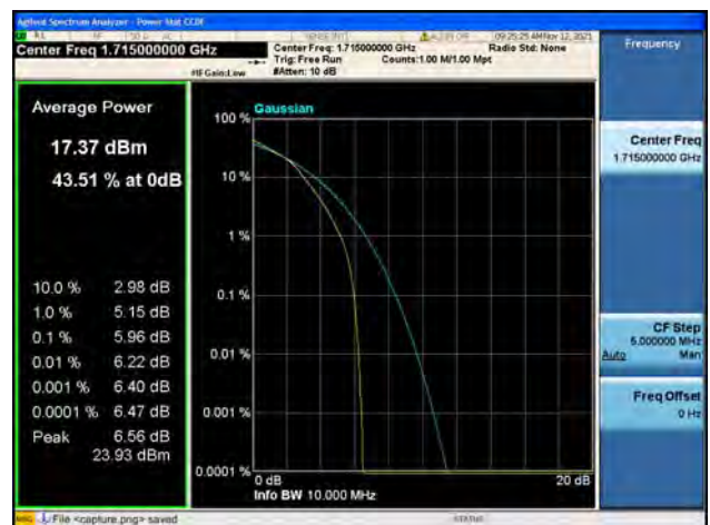
Band4 / 10MHz / Low CH / 64QAM
