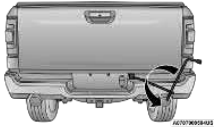
Rotating The Lug Wrench Handle
