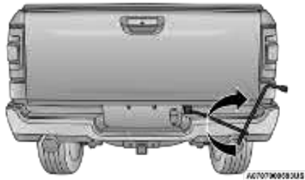
Rotating The Lug Wrench Handle
