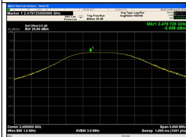
AV Output power - High CH 2480
