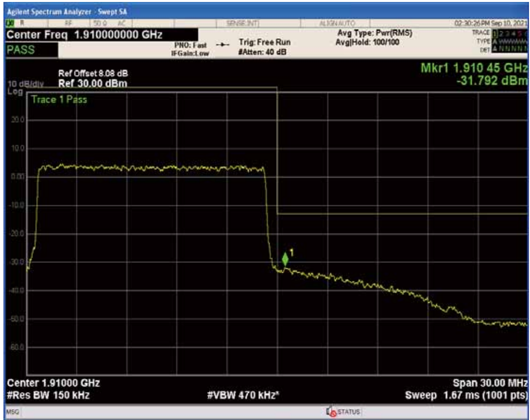
Band2 QPSK BW=20MHz Channel=18700 RB Size=1 Position=#0
