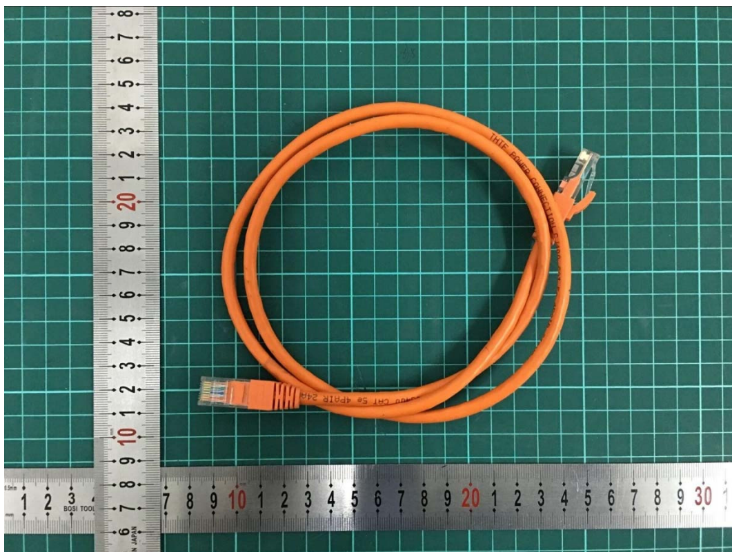
c : Ethernet cables
